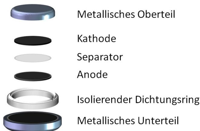
Abbildung 3-7 Schematischer Aufbau der für die Batterietests eingesetzten Knopfzellen
