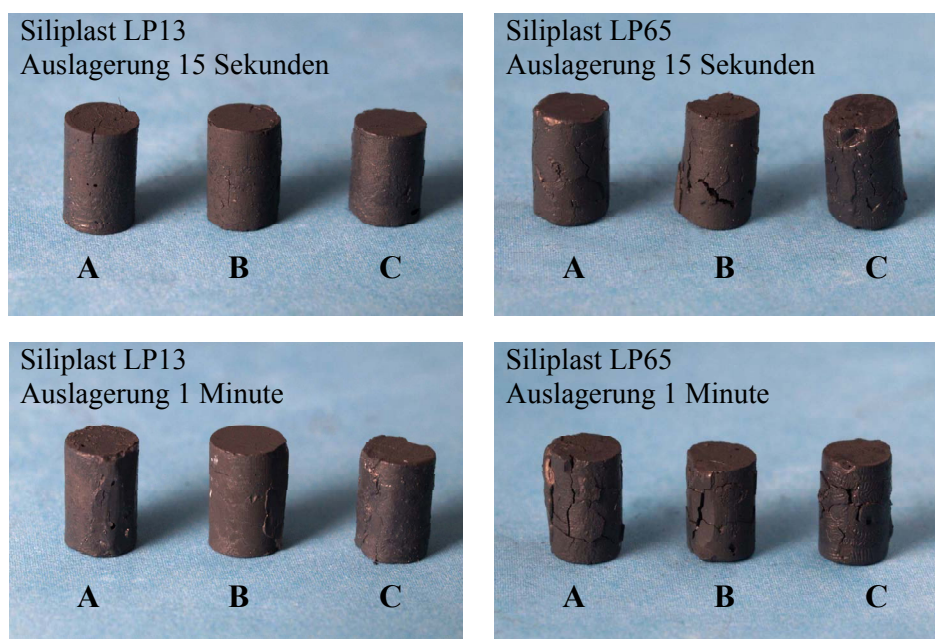
Abbildung 4.46: Thermische Entbinderung von thermoplastischen Massen mit silanisierten Pulvern, die zuvor eine Lösungsmittelentbinderung mit verschiedenen flüssigen Lösungsmitteln erfahren haben (A = Toluol, B = Diethylether und C = Chloroform).
