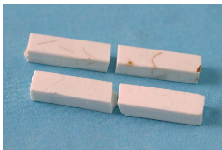
Abbildung 5.12: Dreipunktbiegeproben der thermoplastischen Masse HG01N08N. Die obere Probe wurde mit Aufmaß abgeformt um abschließend mechanisch bearbeitet werden zu können, die untere Probe wurde im Endmaß abgeformt und ohne mechanische Bearbeitung „as fired“ getestet. Beide Proben wurden mit den gleichen Parametern in der Goceram abgeformt.
