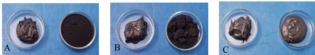
Abbildung 4.23: Verwendete Bindemittel in Kombination mit hydrophoben (jeweils linke Bildhälfte) und hydrophilen (jeweils rechte Bildhälfte) Pulvern (Pulveranteil = 60 Vol.%). A = Terhell Paraffin 6403, B = Siliplast LP13, C = Siliplast LP65.
