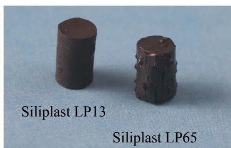
Abbildung 4.45: Thermische Entbinderung bei 5 K/min bis 500°C in der TG/DSC von thermoplastischen Massen silanisierter Pulver (60 Vol.%) mit Siliplast LP13 und Siliplast LP65 als Bindemittel.
