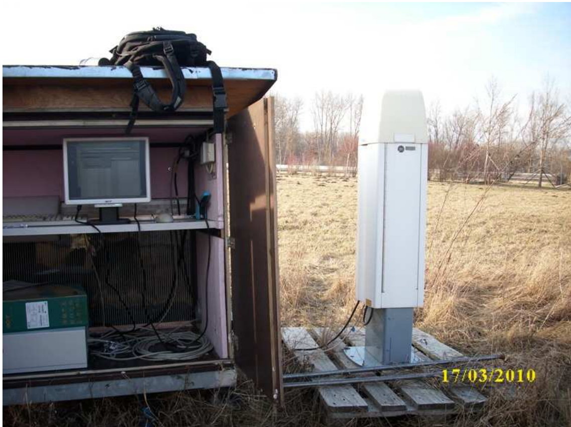
Abbildung 12: Ceilometer CL31 an der AVA Augsburg (eigenes Foto, Mrz 2010)
