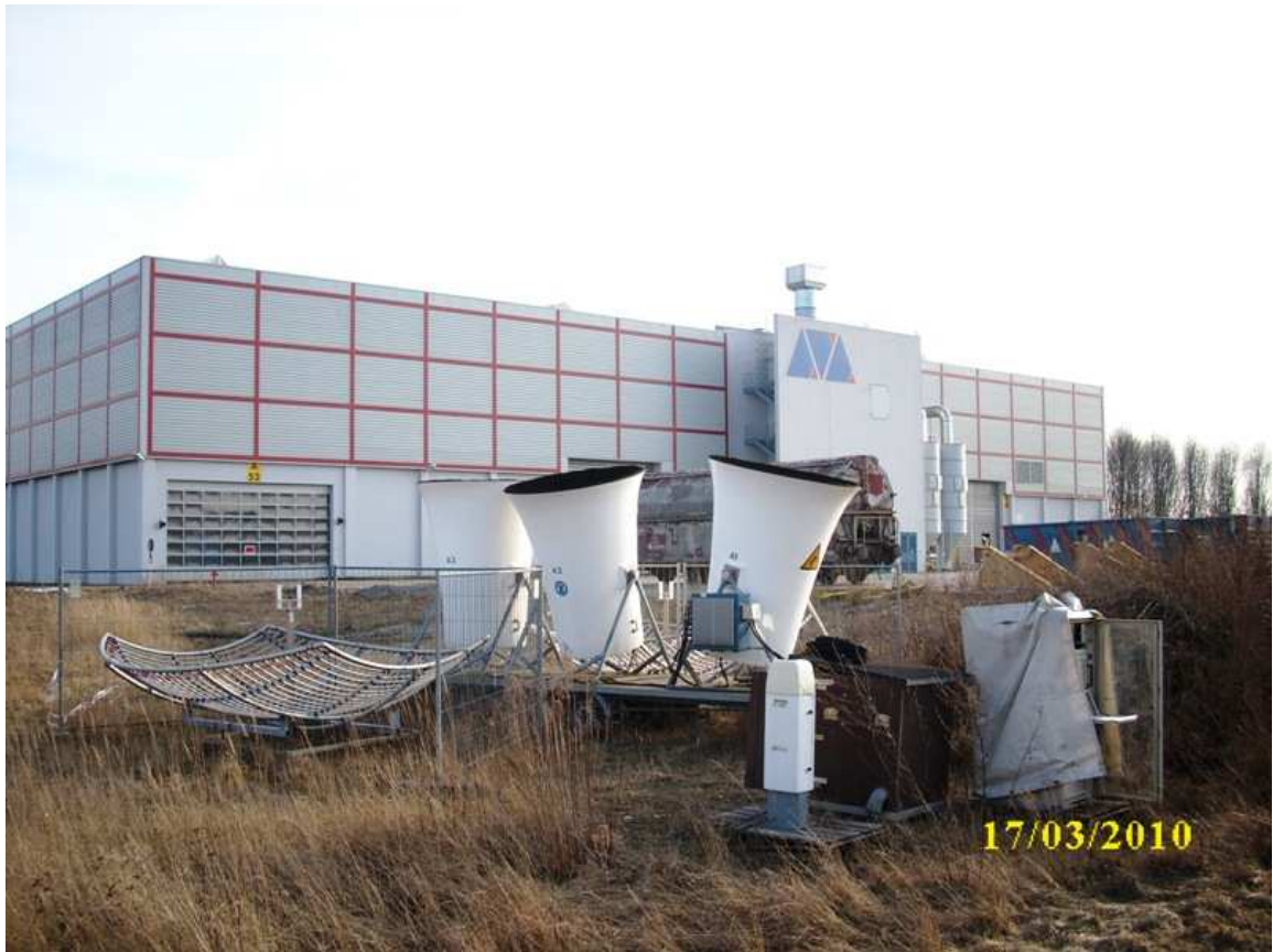
Abbildung 9: Messsysteme am Standort AVA. im Vordergrund das Ceilometer, mittig die SODAR-Antennen, bzw. rechts und links davon die RASS-Antennen (Quelle: eigenes Foto, Mrz. 2010)
