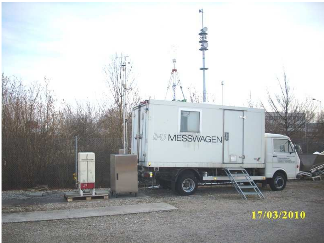
Abbildung 11: Messwagen des IMK-IFU am Standort BfA. Links neben dem Messwagen: LD40-LIDAR (links), PM10-Messgerät (rechts), USA auf dem Dach, Ansaugkopf für Schadstoffmessung im Bild rechts neben dem Sendemast im Hintergrund. (Quelle: eigenes Foto Mrz. 2010)
