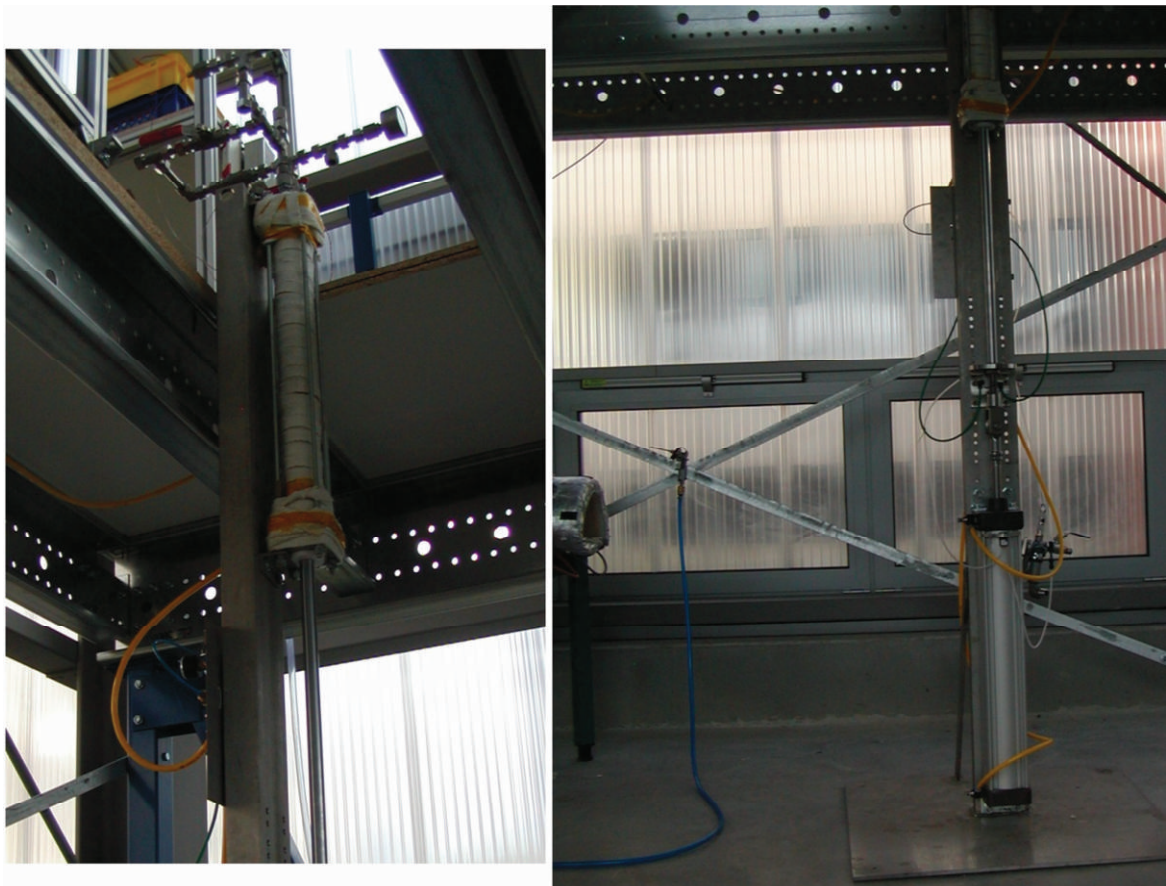
Abbildung 42: Laborverdichter mit beheiztem Kompressionszylinder
