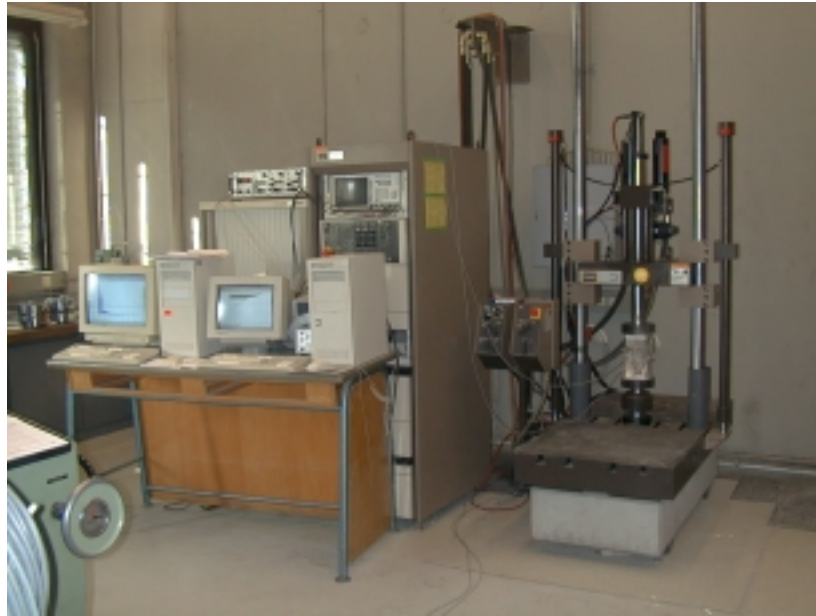
Abb. 3.10: Blick auf die gesamte Versuchsanlage während eines einachsigen Zugversuches
