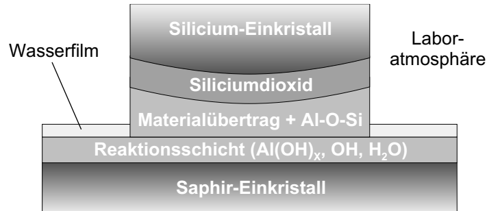
Bild 5.36: Schematische Darstellung der angenommenen Kontaktbedingungen bei den Reibungs- und Abrißkraftmessungen zwischen Saphir und Silicium.
