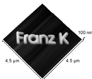
Bild: RKM-Topographie einer auf Silicium mittels elektronenstrahlinduzierter Deposition erzeugten Me 2 Au(tfac)-Struktur (Deposition: J. Kretz, IAP TH Darmstadt 1993)
