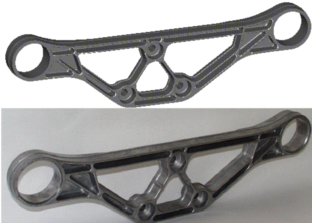
Abb. 32 Auf Basis der Topologieoptimierung konstruiertes Teil als CAD-Modell (oben) und Versuchsteil (unten)
