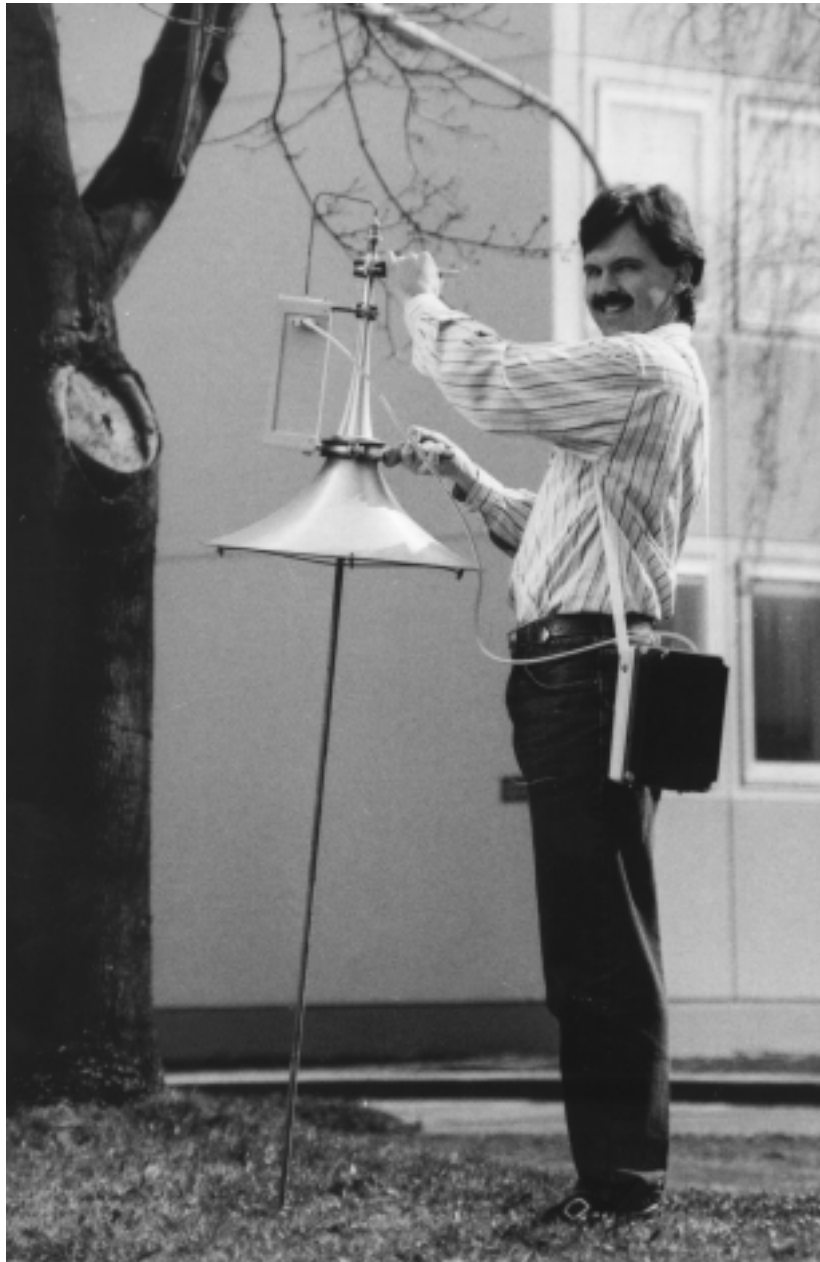
Abbildung 6.12: Oberflächensensor im praktischen Einsatz. Die hochfrequente Meßschaltung wurde von Ulbrich (1993) entwickelt.
