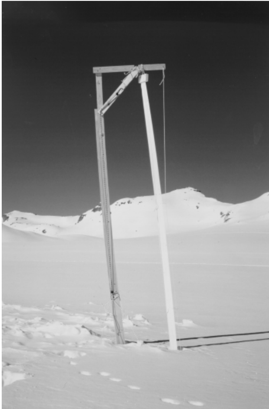
Abbildung 7.34: Ansicht des vertikalen Schneehöhenmeßkabels nach geringem Schneefall.
