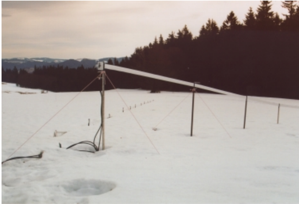
Abbildung 7.45: Schräg zum Erdboden ausgespanntes Meßkabel auf dem Schauinsland 1998.
