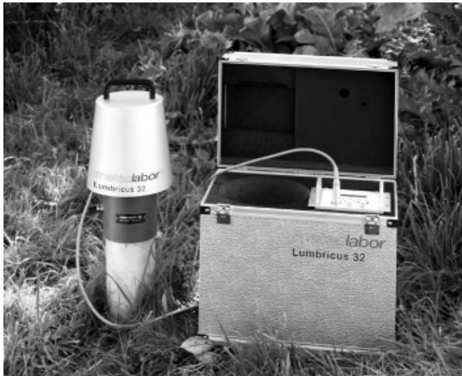
Abbildung 5.6: Bodenfeuchtemessung mit LUMBRICUS (Mit freundlicher Genehmigung der Fa. Meteolabor AG, Wetzikon, Schweiz).
