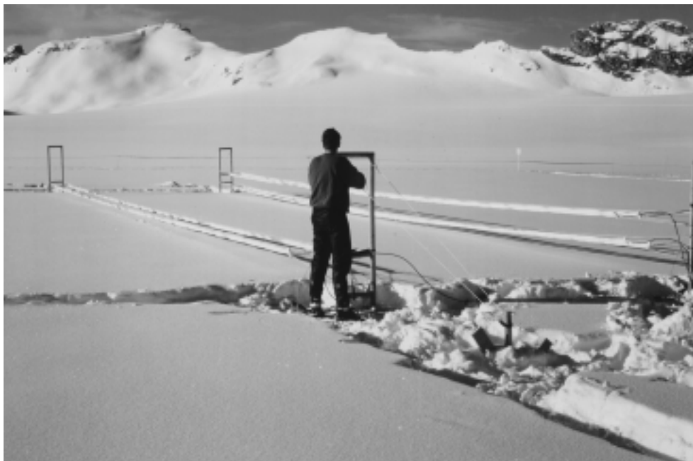
Abbildung 7.33: Ansicht der horizontalen Schneefeuchtemeßkabel kurz nach dem Aufbau.
