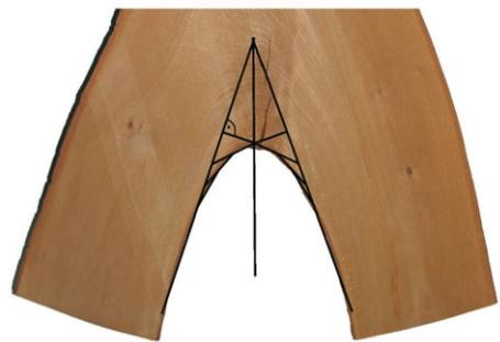
Konstruktionsvorschrift für die Formoptimierung einer Kerbe unter einachsigem Zug mit der Methode der Zugdreiecke.
