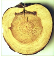
Wachstumswülste neben Kerbspannungen
