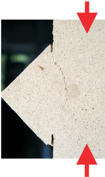
Ein Stück Kalksandstein wird im Labor schwellend auf Druck belastet. Es entsteht ein Riss, der den unterbelasteten Teil abwirft und in etwa mit Zugdreiecken beschrieben werden kann.
