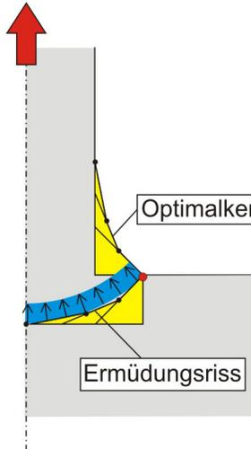
Bei Ermüdungsrisen fällt auf, dass oft die Kontur des Ermüdungsrisse gleich der um 90° gedrehten Optimalkerbkontur ist.
