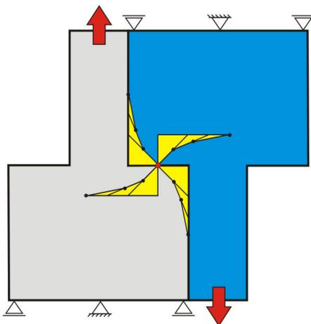
Eine weitere Rotationssymmetrieeigenschaft wird bei parallelen um 180° zueinander verdrehten Wellenschultern deutlich.
