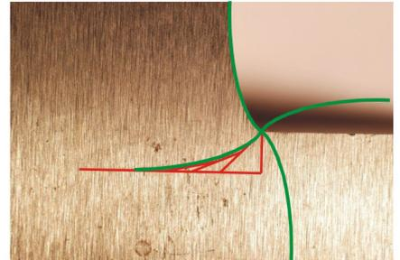
Optimalkerbkontur, Ermüdungsriß und Kontur der Faulpelzecke wären dann jeweils identisch und um 90° versetzt.
