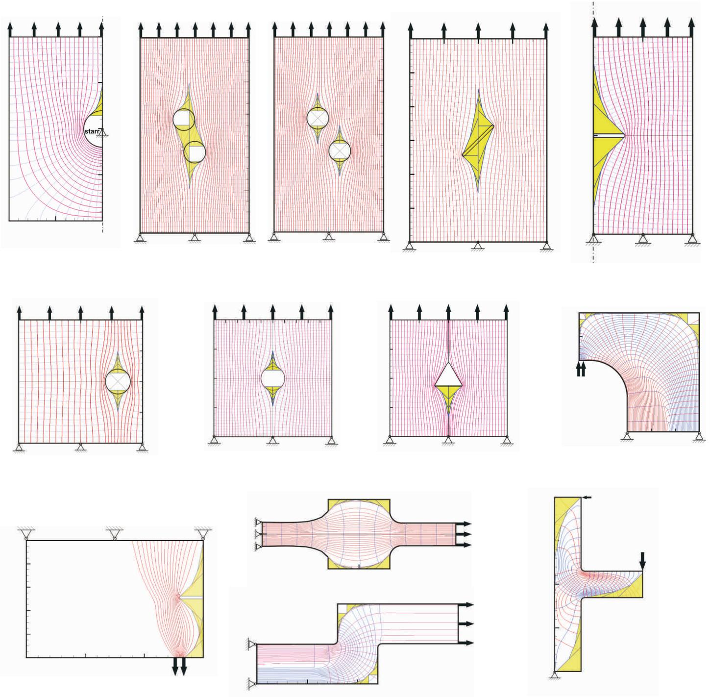
Die Methode der Zugdreiecke enttarnt hier Faulpelzecken um Perforationen und bestimmt die mechanisch effektive Form der Perforation, die allein von Fasern umsteuert werden muss. Faulpelzecken braucht man nicht mit Fasern verstärken. Konstruktionspraxis 7/2009, 18- 19
