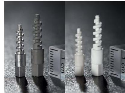
Abb. 4: Dispenserschnecke aus 17-4PH Stahl (links) und  $\text{ZrO}_2$  (rechts)
