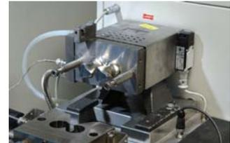
Abb.1: Kneiter zur Produktion von Formmassen
