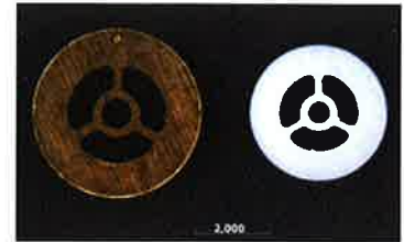
Lagerschild Urmodell (Messing) & Prototyp (ZrO 2 )
