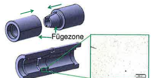
Turbinengehäuse und Aufnahme der Fügezone
