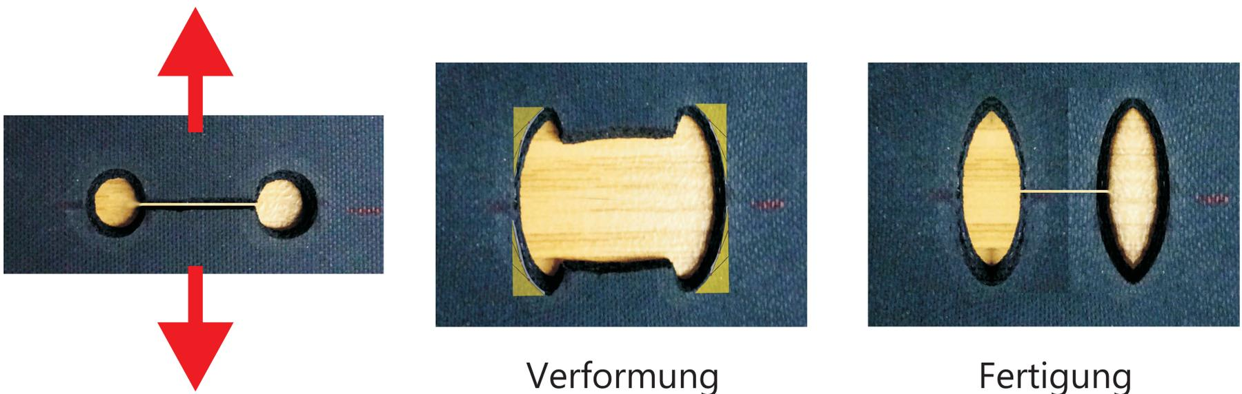
**Fazit:** Risse in sehr dehnbaren Materialien verbessern ihre Ausrichtung. Die Verformung von Abschlussbohrungen an Rissenden zeigt an, wie man in weniger dehnbaren Materialien die Rissenden lastgerecht ausformen sollte.
