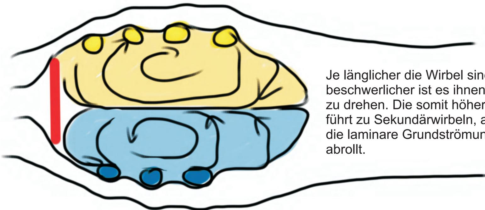
Je länglicher die Wirbel sind, desto beschwerlicher ist es ihnen schnell zu drehen. Die somit höhere Reibung führt zu Sekundärwirbeln, auf denen die laminare Grundströmung leichter abrollt.
