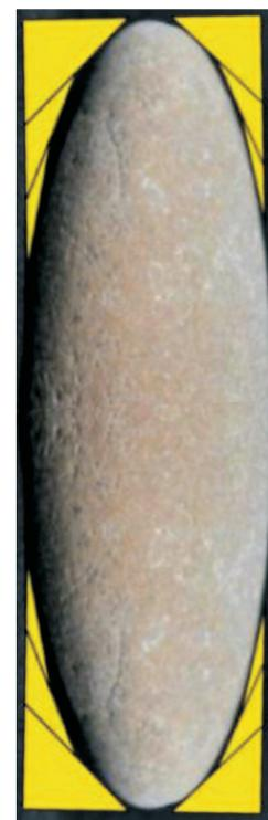
**Fazit:** In einer elastischen Platte zieht eine Linienlast hier eine bachkieselförmige Umgebung mit. In einer elasto-plastischen Platte bilden sich plastische Verschiebungen in Bachkieselform aus. Dies lässt eine innere Optimierung durch Deformation erahnen, die an eine elastische Strömung erinnert.
