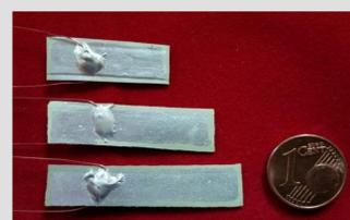
Mehrlagige piezoelektrische Biege-wandler mit interdigitaler Innenelektrodenstruktur wurden durch sequentielles Gießen eines keramischen Schlickers sowie einer modifizierten Silberpaste und anschließendem Co-Firing des sog. co-gecasteten Mehrlagenverbundes hergestellt. Das Auftragen von Außenelektroden sowie die Kontaktierung der Innenelektroden sowie erfolgt noch manuell (→ PVD).
