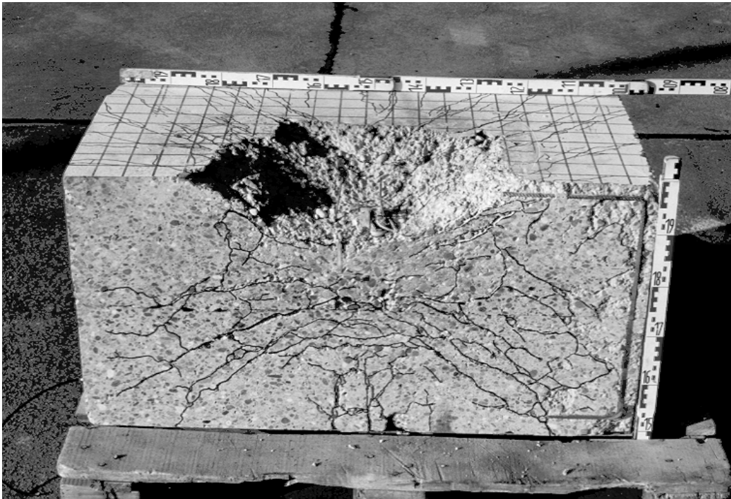
Abbildung C 17 Platte 3 vertikal gesägt, Rissbildung im Innern der Platte
