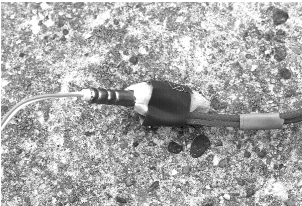
Abbildung I 14 Zündverteiler Balken VK2, der Momentenzünder (links), soll die Detonation über eine kleine Menge Seismoplast auf zwei Sprengschnüre gleicher Länge (rechts) übertragen
