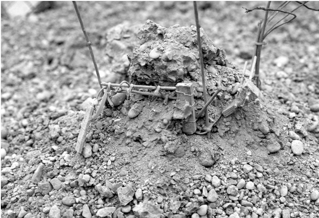
Abbildung C 9 Sprengergebnis Platte 2, Detaildarstellung der Überreste des Positionsgitters inmitten von kompaktiertem Material
