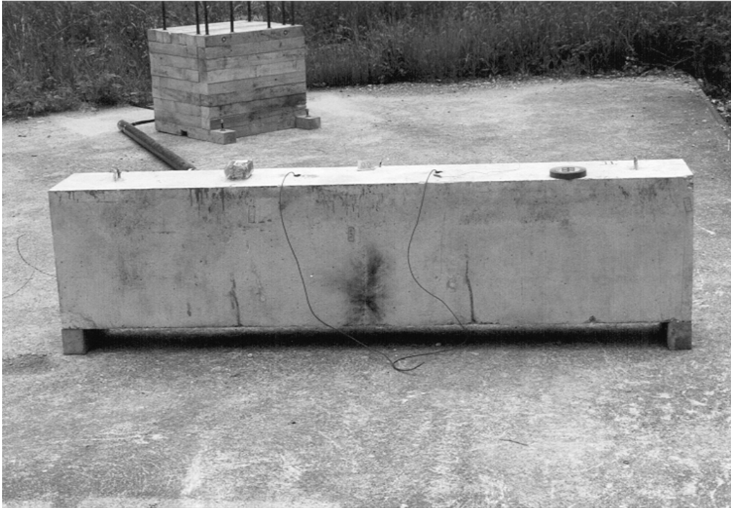
Abbildung I 13 Versuchsaufbau Balken VK2 vor Versuch, zwei Bohrlöcher
