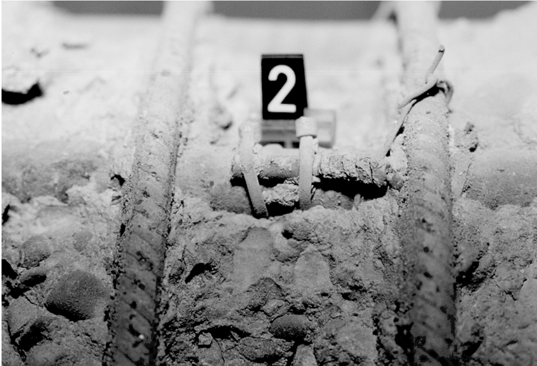
Abbildung K 13 Überreste des Kohle-Masse-Aufnehmers AB2
