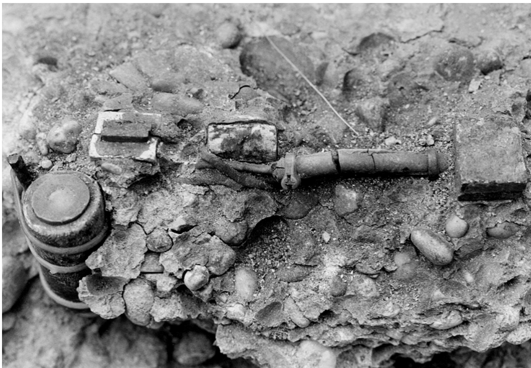
Abbildung C 30 Sprengergebnis Platte 5, Detaildarstellung des im Krater freigelegten Positionsgitters
