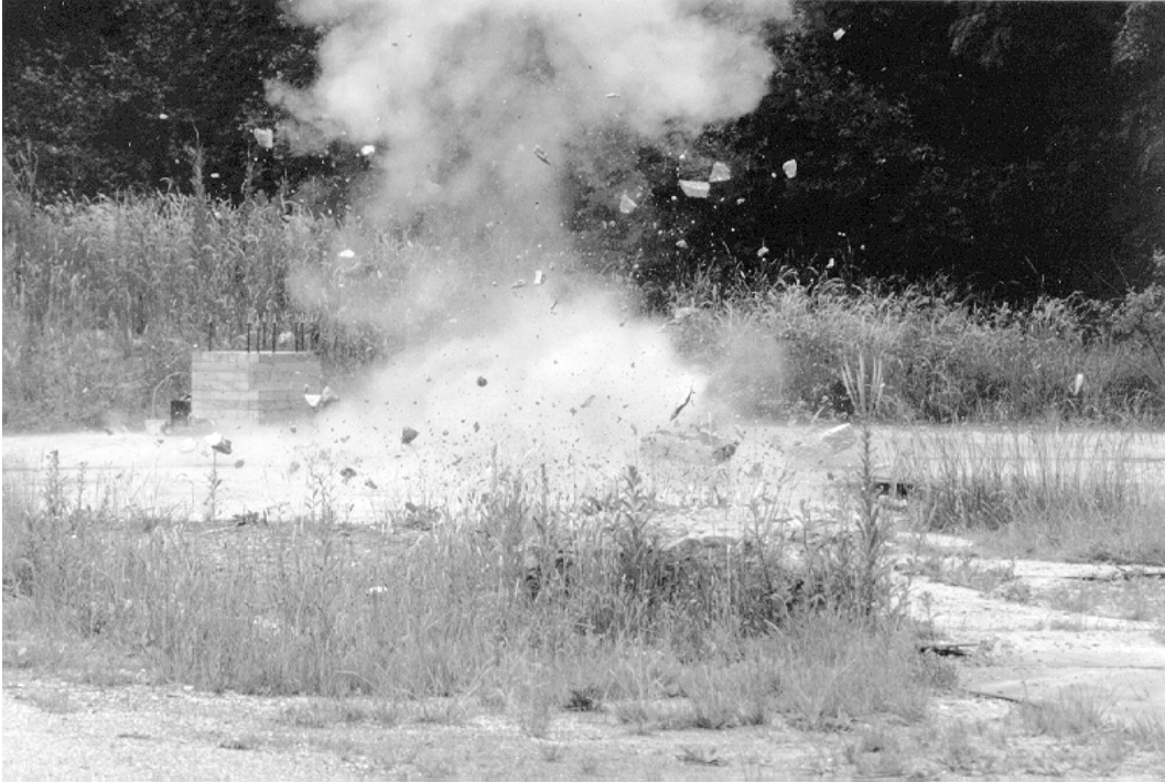
Abbildung 6-13 Sprengung Balken VK4, Fragmentierung während des Versuchs, die Trümmer verteilen sich in einem Radius von etwa 12 m
