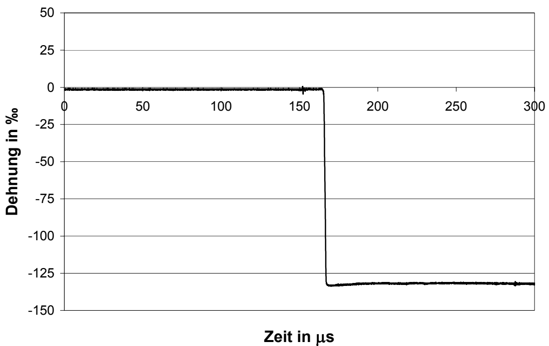
Abbildung E 12 Messkurve des Aufnehmers DMS2, Einbautiefe h = 9 cm
