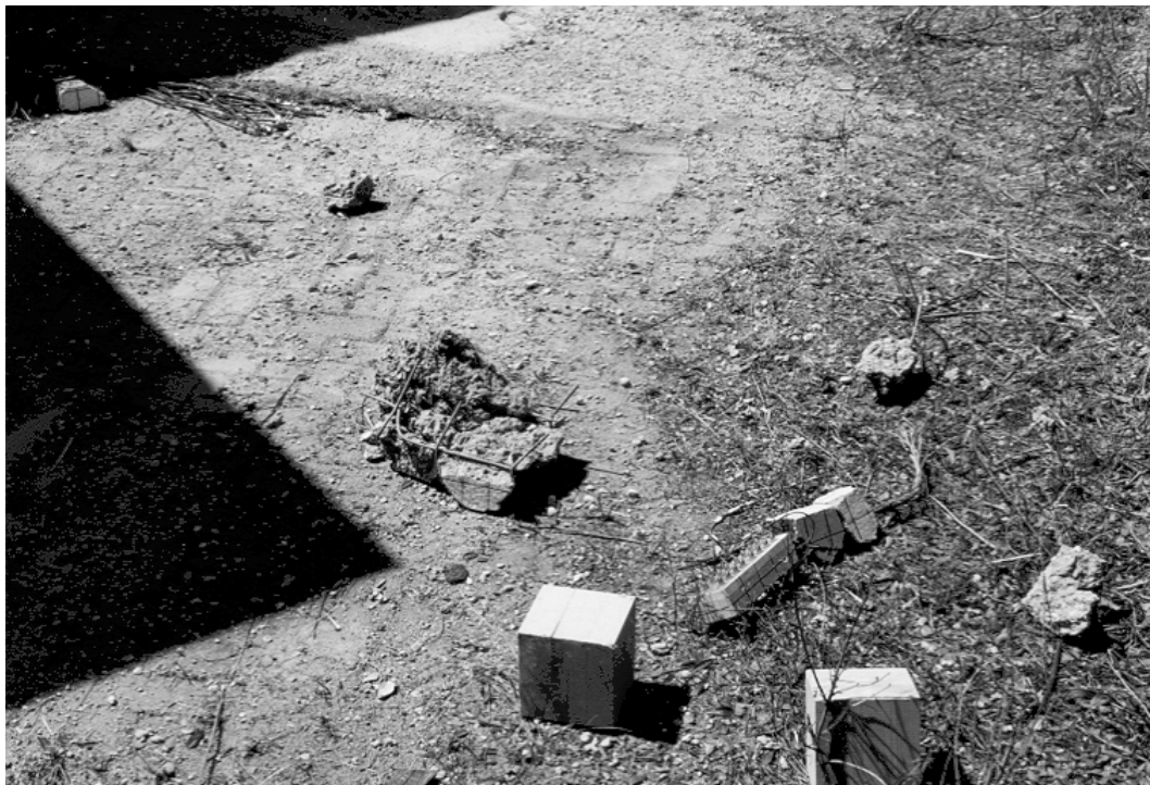
Abbildung C 2 Sprengergebnis Platte 1, totale Zerstörung
