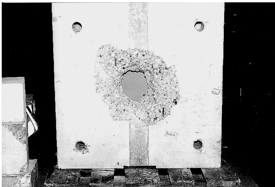
Abbildung A 12 Rückseite der durchschossenen Platte aus Vorversuch V3
