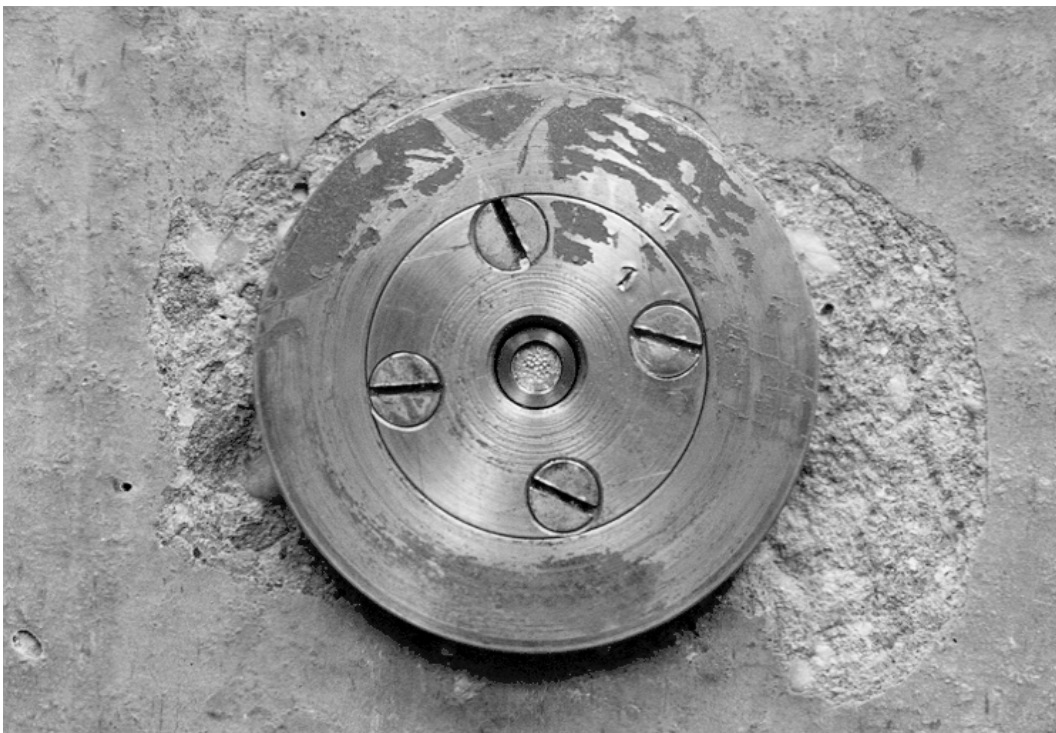
Abbildung K 6 Detail, Luftdruckaufnehmer im Innern des Zylinders
