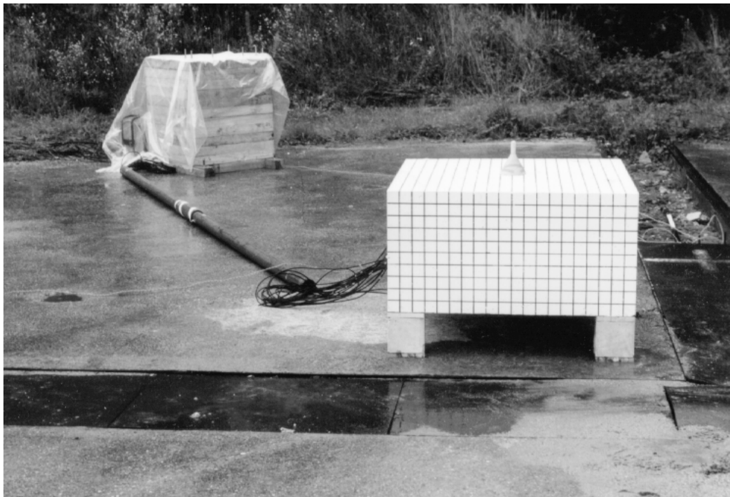
Abbildung 5-9 Versuchsaufbau mit Einhausung für die Zwischenverstärker am Beispiel der Platte 3
