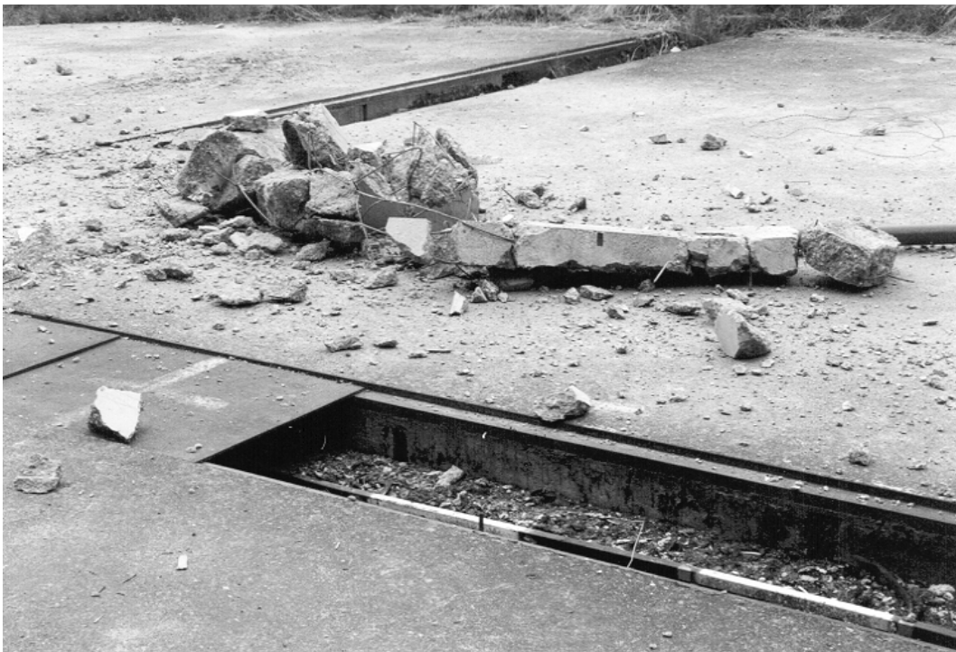
Abbildung I 28 Sprengergebnis Balken VK4, totale Zerstörung
