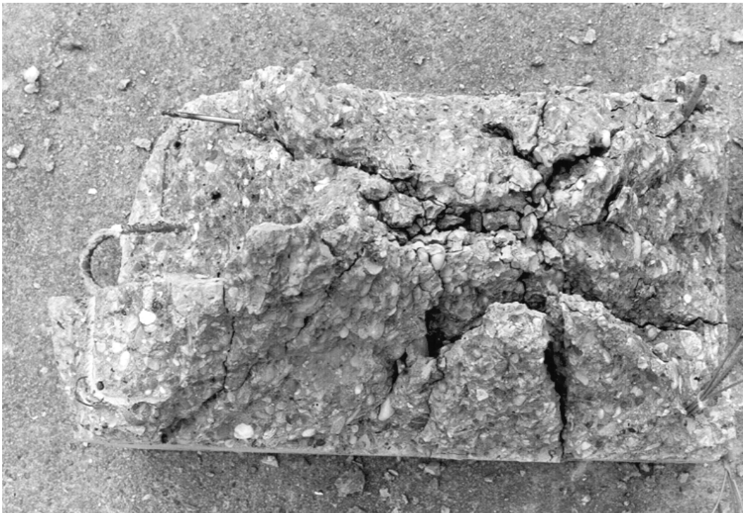
Abbildung I 6 Sprengergebnis Balken VK1a, größtes auffindbares Fragment
