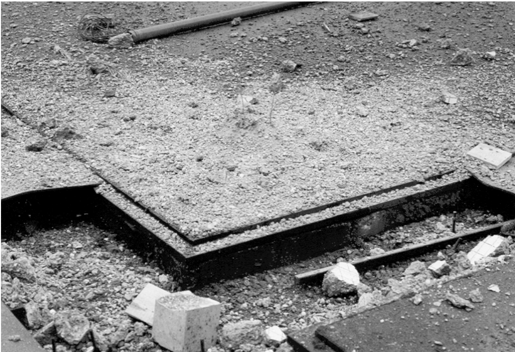
Abbildung C 8 Sprengergebnis Platte 2, ursprünglicher Standort der Platte
