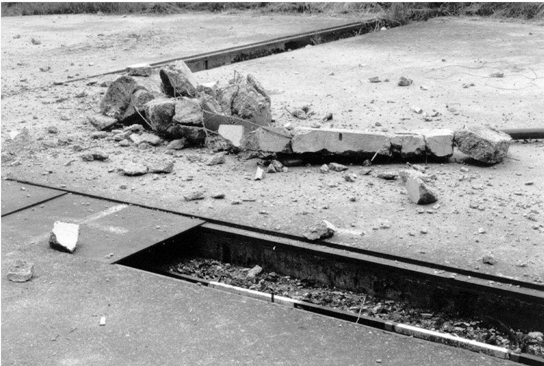
Abbildung 6-14 Sprengergebnis Balken VK4, größere Fragmente werden von der Bewehrung zusammengehalten, kleinere Trümmer sind in der Umgebung verteilt
