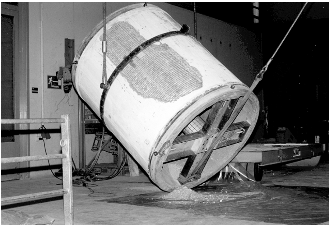
Abbildung K 10 Drehen des Zylinders zum Ausbau der Stütze, entstandene Fragmente werden aufgefangen
