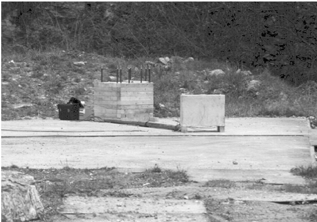
Abbildung I 10 Versuchsaufbau Balken VK1c vor Versuch, ein Bohrloch
