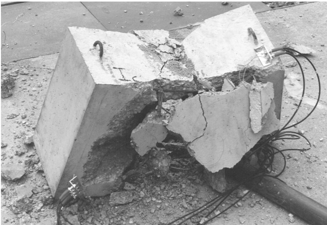
Abbildung 6-8 Balken VK1c nach dem Versuch
