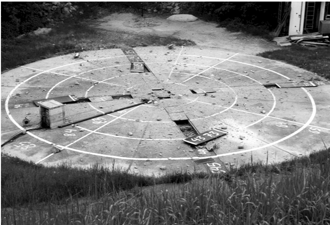
Abbildung C 22 Sprengergebnis Platte 4, totale Zerstörung
