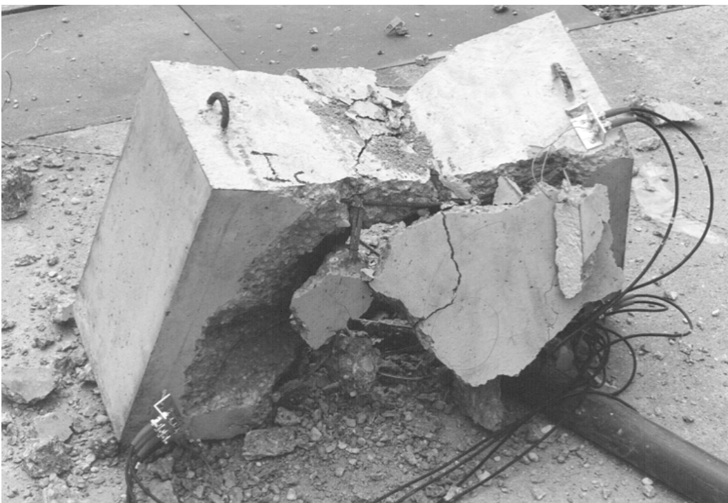
Abbildung I 12 Sprengergebnis Balken VK1c, totale Zerstörung, jedoch noch geringere Fragmentierung als bei den Balken VK1a und VK1b
