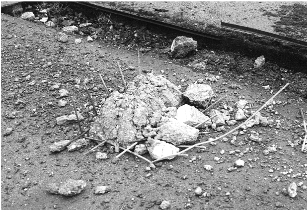
Abbildung C 10 Sprengergebnis Platte 2, größtes auffindbares Fragment
