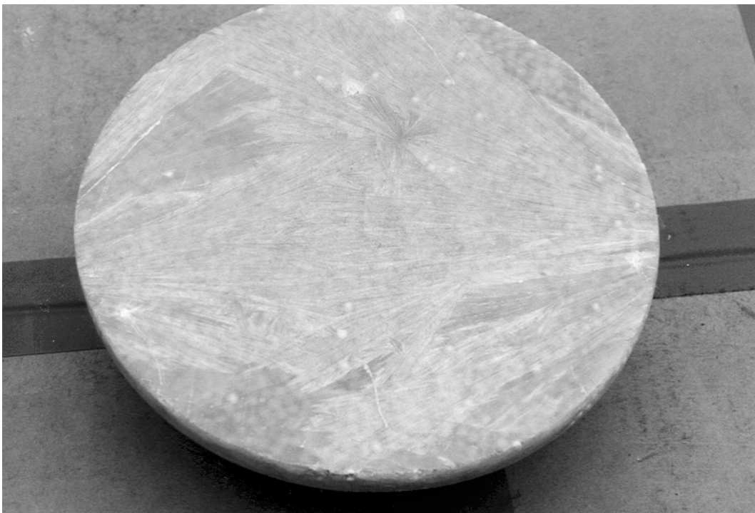
Abbildung C 26 Versuchsaufbau Platte 5, Unterseite des phlegmatisierten Plane-Wave-Generators
