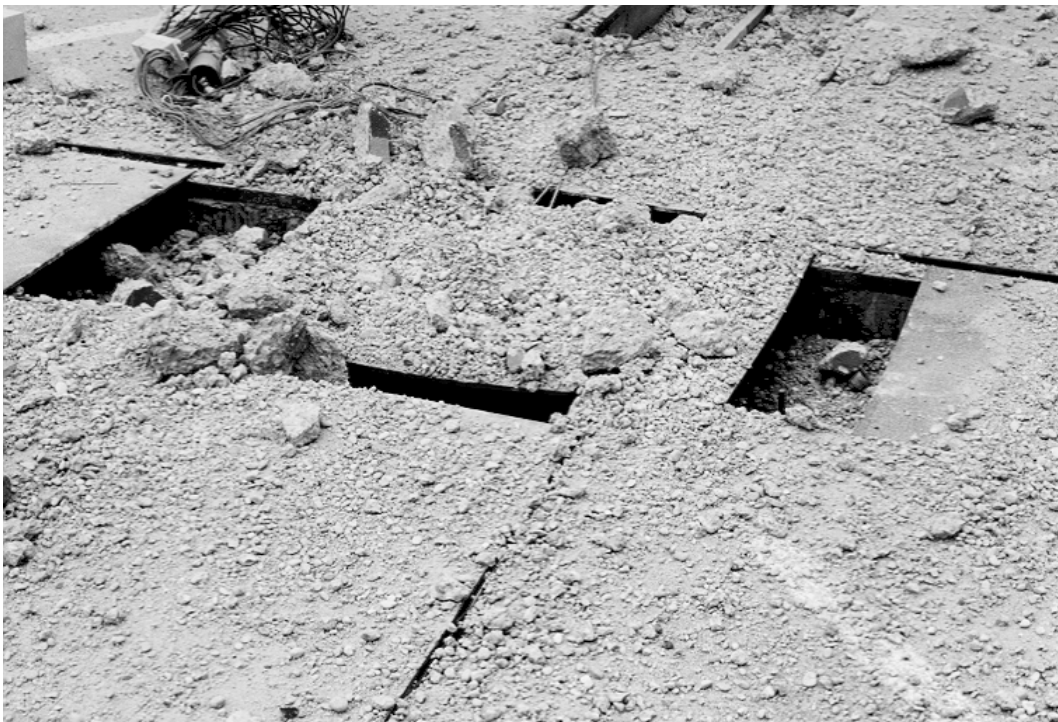
Abbildung C 24 Sprengergebnis Platte 4, ursprünglicher Standort der Platte
