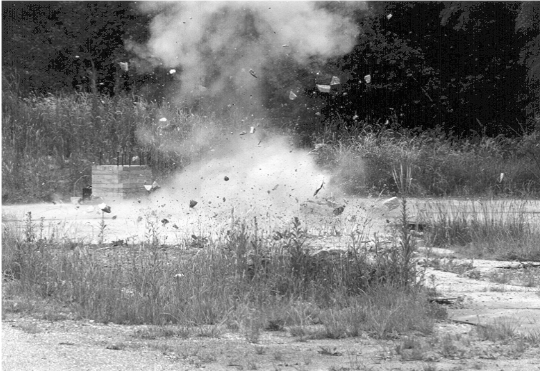
Abbildung I 27 Versuchsablauf beim Versuch am Balken VK4, Trümmerflug
