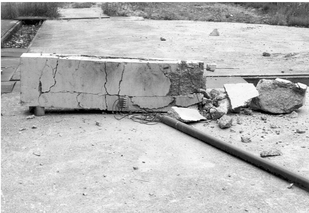
Abbildung I 20 Sprengergebnis Balken VK3, totale Zerstörung
