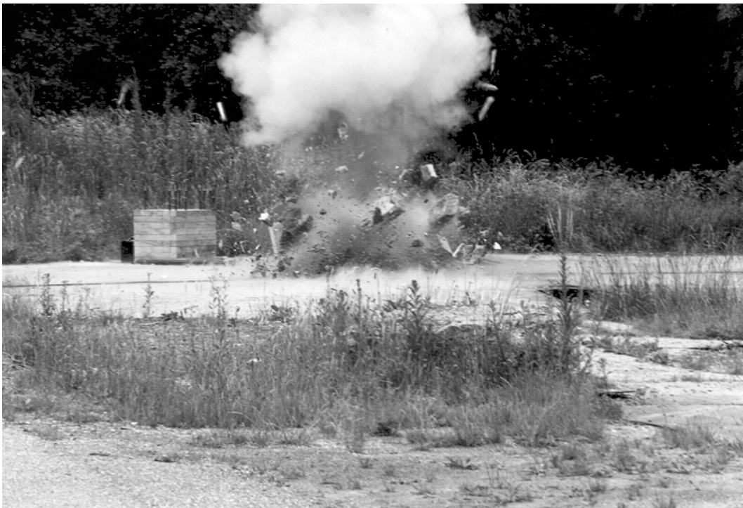
Abbildung I 26 Versuchsablauf beim Versuch am Balken VK4, Fragmentierung
