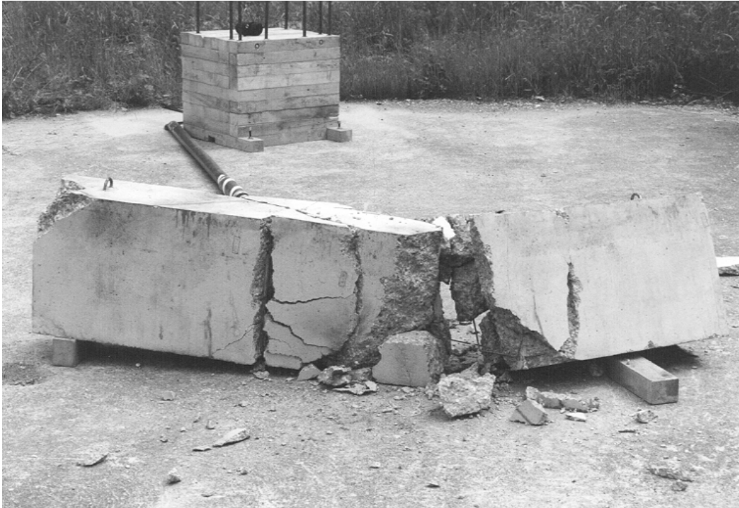
Abbildung I 17 Sprengergebnis Balken VK2, nach der Detonation der zweiten Bohrlochladung
