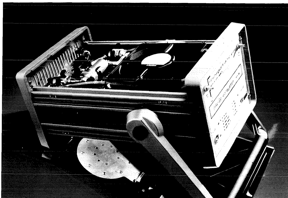
Abbildung 6.7: Aufnahme des SAGAS-Sensorsystems mit geöffnetem Gehäuse. Das Sensorsystem steht auf einem Spiegel, in dem sich das OFW-Sensorarray spiegelt. Oben rechts ist die Lüftereinheit zu erkennen, die die Abwärme der Temperaturregelung abführt. Darunter befindet sich das Meßwerterfassungsmodul. Links oben im Gehäuse ist das Gasfluidiksystem sichtbar.
