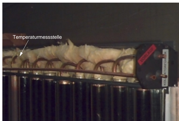
Abbildung 3.6.: Blick in den geöffneten Headerbereich eines SOLVIS Luna Kollektors
