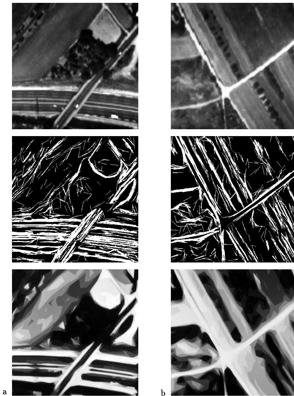
Abb. A-4: Ungestörte Bilder a) Autobahnbrücke b) Wegkreuzung oben: Originalbilder Mitte: extrahierte Geradenstücke unten: rekonstruierte Bilder
