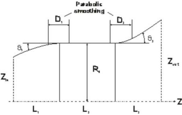
Fig. 1 Cavity geometry for  $TE_{24,8}$  ( $L_1=12 \text{ mm}$ ,  $L_2=16 \text{ mm}$ ,  $L_3=18 \text{ mm}$ ,  $q_1=2.3^\circ$ ,  $q_2=0.0^\circ$ ,  $q_3=3.0^\circ$ )
