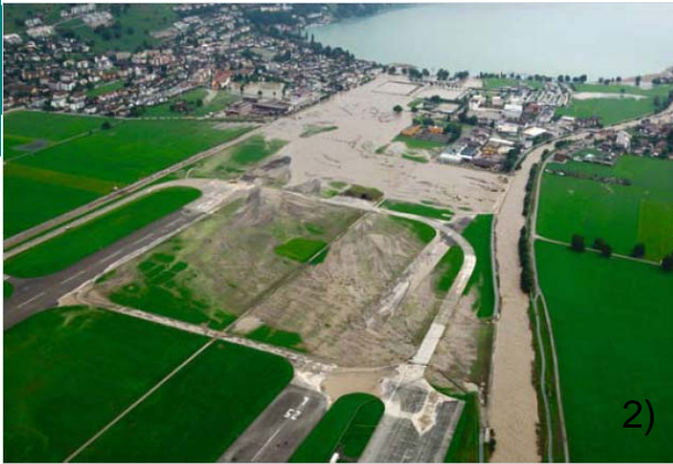
Abbildung 3: Im August 2005 wurde das Hochwasser der Engelberger Aa um das Schadenempfindliche Siedlungsgebiet geleitet. (Quelle: Schweizer Luftwaffe 2005)
