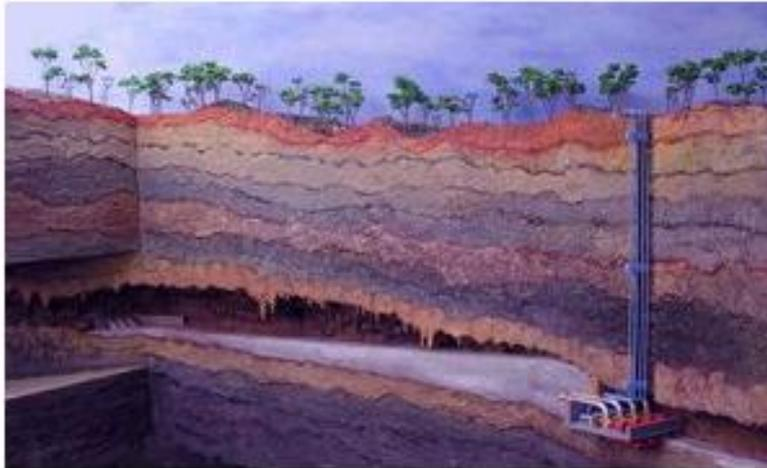
Prinzipskizze der unterirdischen Anlage mit 100 m Steigleitung
