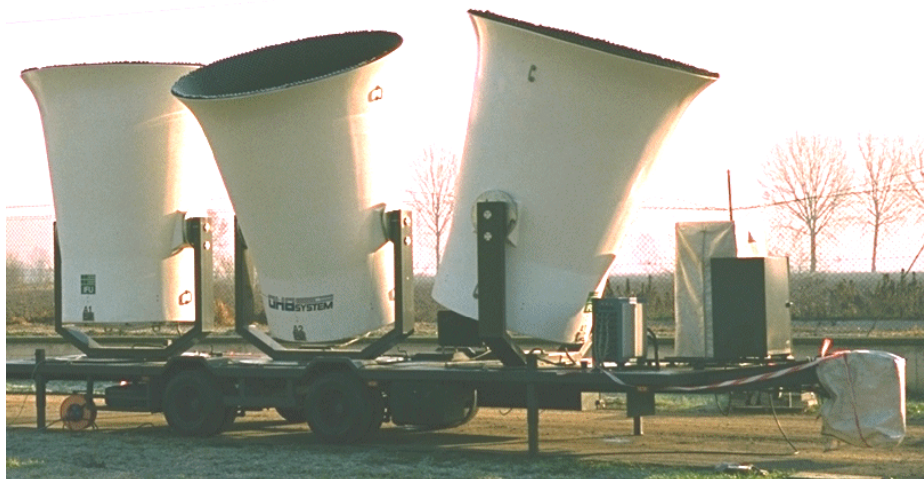
Drei-Antennen SODAR Reichweite: ca. 1 km
