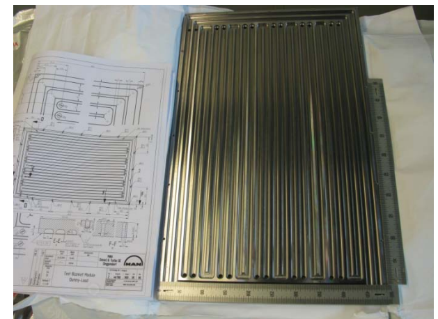
1:3 FW mock-up: pre test ior diffusion welding. Rey, von der Weth, Neuberger (KIT), 2012.
