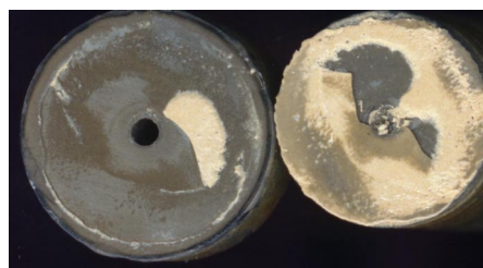
Abbildung 4.3.7: Beispiel für typische Mischform des Versagens; Zahnkeramik teilweise ausgebrochen und stellenweise Ablösung in der oberen und unteren Grenzfläche.
