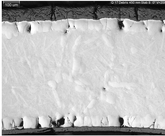
1250 K outer ZrO 2 100 μm; α-Zr(O) 70 μm; inner ZrO 2 30 μm; α-Zr(O) 80 μm
