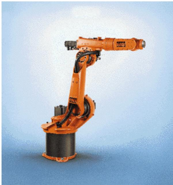
Abbildung 3.3: Testsystem Kuka KR15/2[139]
