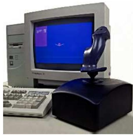
Abbildung 1.4: Kraftreflektierender Joystick des DLR
