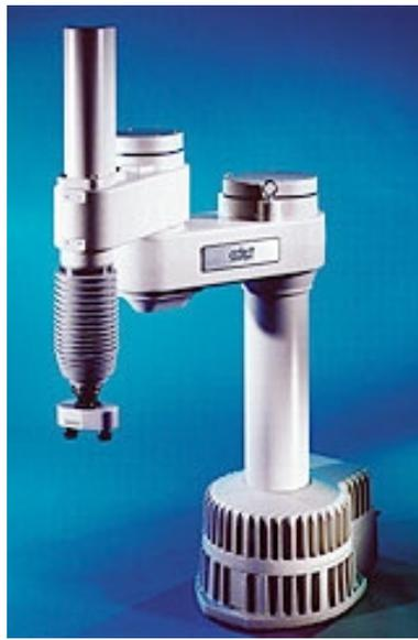
Abbildung 3.7: Direkt angetriebener Horizontalknickarmroboter (Roboter vom SCARA Typ) [2]
