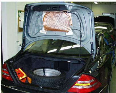
e) Spirale unter Kunststoffheckklappe
