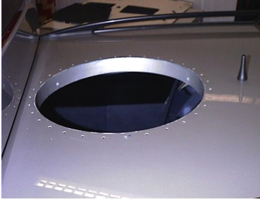
Bild 4.50: Für Breitbandantenne vorgesehene Öffnung in einem Mercedes E-Klasse Kombi-Fahrzeug
