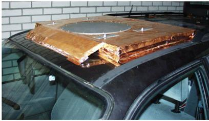
a) Spiralantenne in kupferbeschichtetem Aufbau
