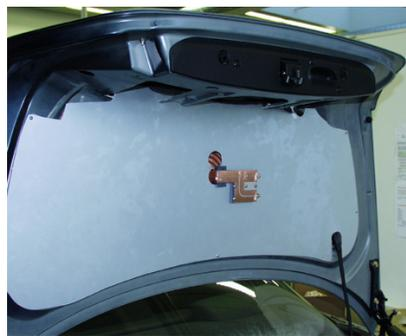
f) Reflektor für Kunststoffheckklappe
