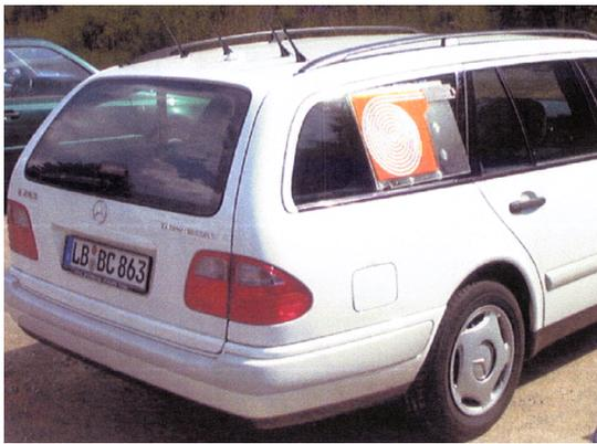
Bild 3.12: Anbringung der Spirale an die Seitenscheibe für die DAB-Messfahrt zwischen Blaupunkt-Gelände und Emmerke bei Hildesheim
