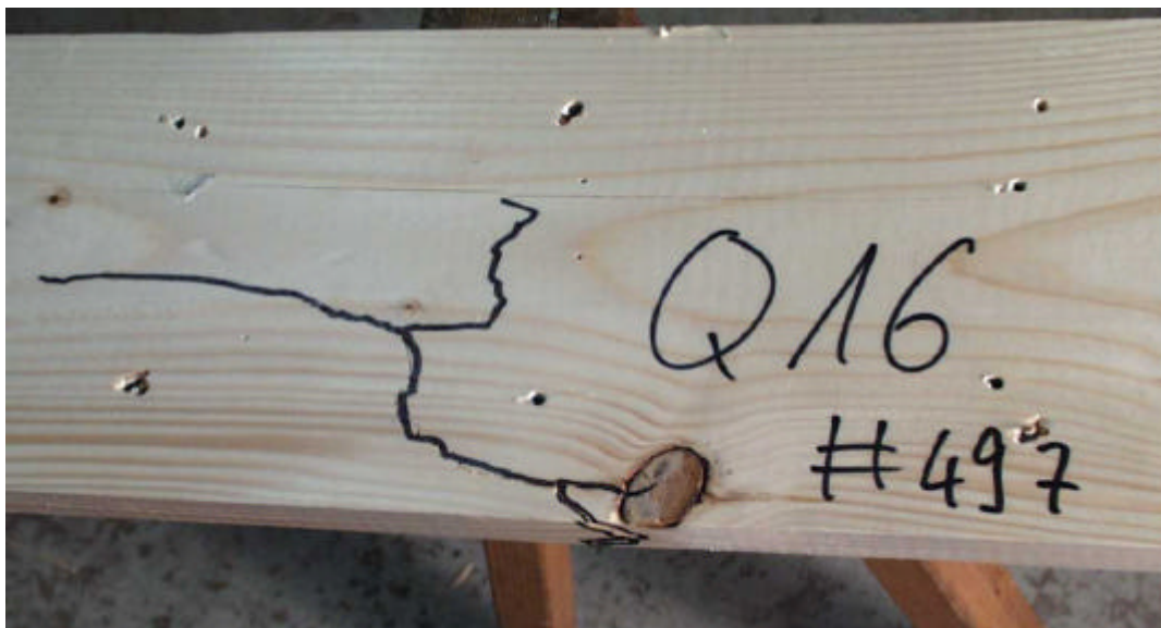
Bild D- 9 Biegeversagen einer Lamelle infolge eines Astes im Biegezugbereich
