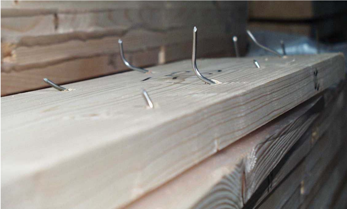
Bild 3- 10 Geöffneter Prüfkörper, verformte Nägel
