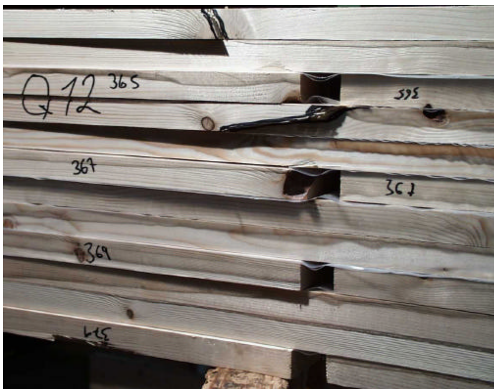
Bild D- 10 Aufspalten von Lamellen eines Prüfkörpers entlang der unteren Nagelreihe
