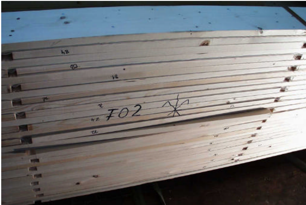
Bild D- 15 Untersicht eines Prüfkörpers mit wechselseitig gestoßenen Lamellen, lokales Durchstanzen der Lamellen
