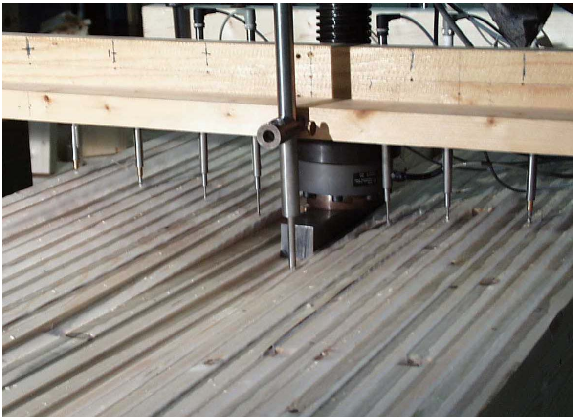
Bild 6- 5 Lasteinleitung und Wegaufnehmer - zentrische Einzellast
