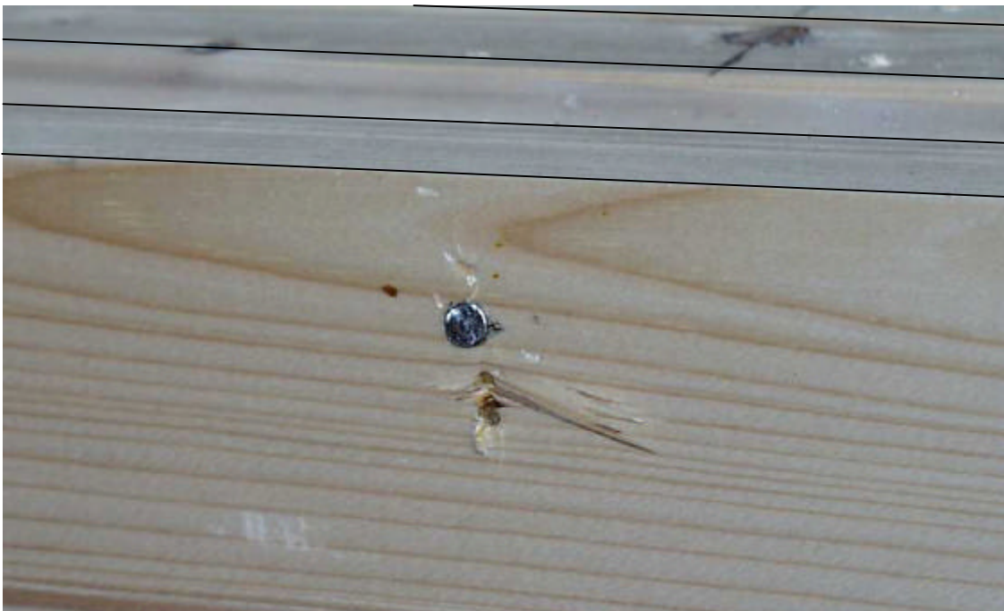
Bild D- 22 Detailaufnahme: Erreichen der Lochleibungsfestigkeit einer Lamelle
