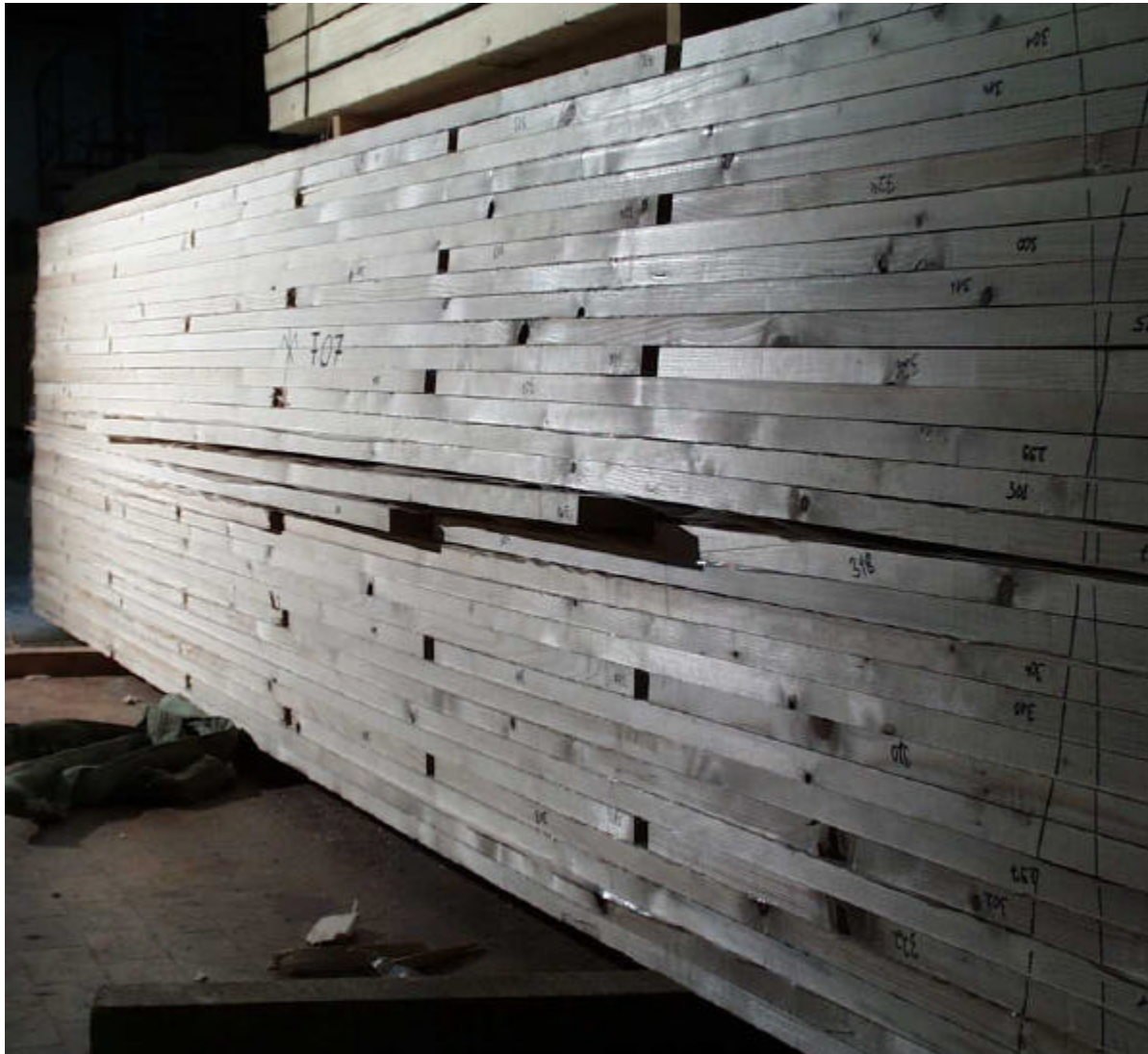
Bild D- 14 Untersicht eines Prüfkörpers mit wandernd gestoßenen Lamellen, Versagen durch Erreichen der Nageltragfähigkeit (lokales Durchstanzen der Lamellen)
