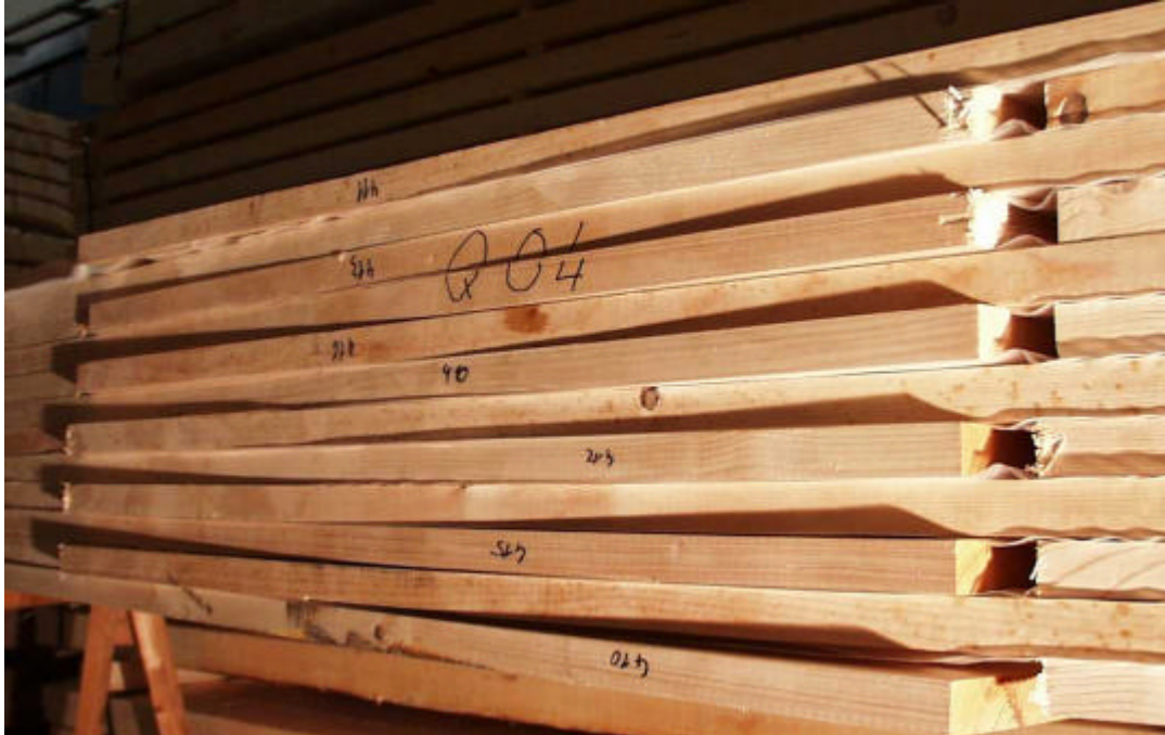
Bild D- 12 Gegenseitig abgescherte Lamellen infolge Erreichen der Nageltragfähigkeit
