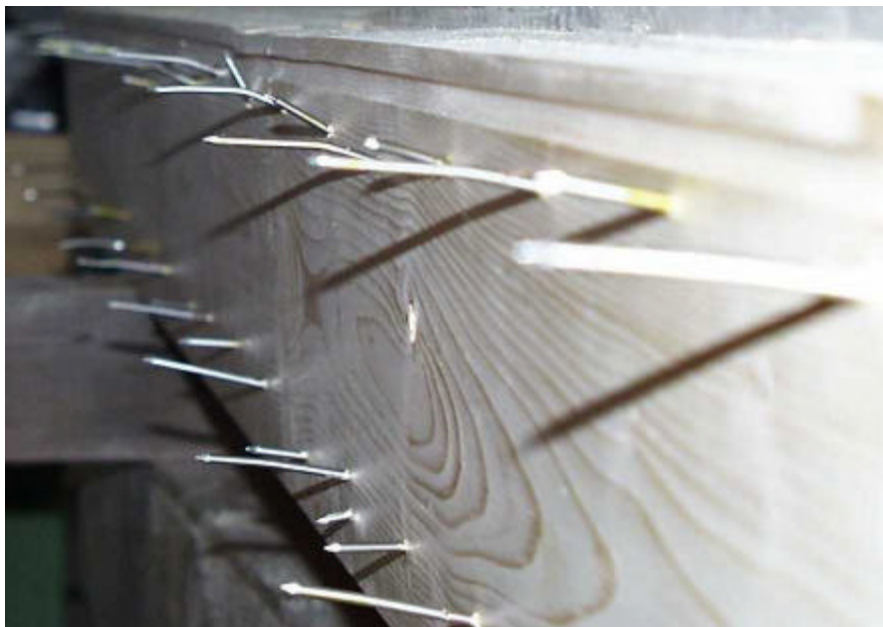
Bild D- 19 Geöffneter Prüfkörper, Nägel im Zick-Zack-Muster, obere Nagelreihe
