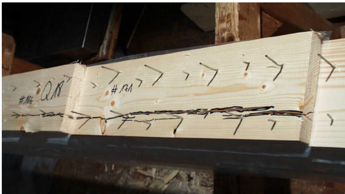
Bild D- 10 Aufspalten von Lamellen eines Prüfkörpers entlang der unteren Nagelreihe
