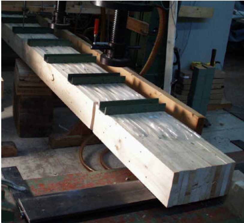
Bild D- 24 Einbau der acht Quertraversen zur Simulation einer Flächenlast
