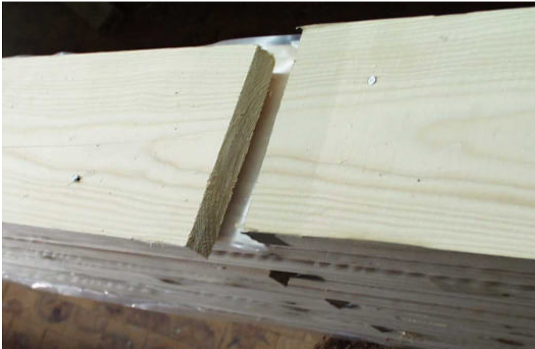
Bild D- 12 Gegenseitig abgescherte Lamellen infolge Erreichen der Nageltragfähigkeit
