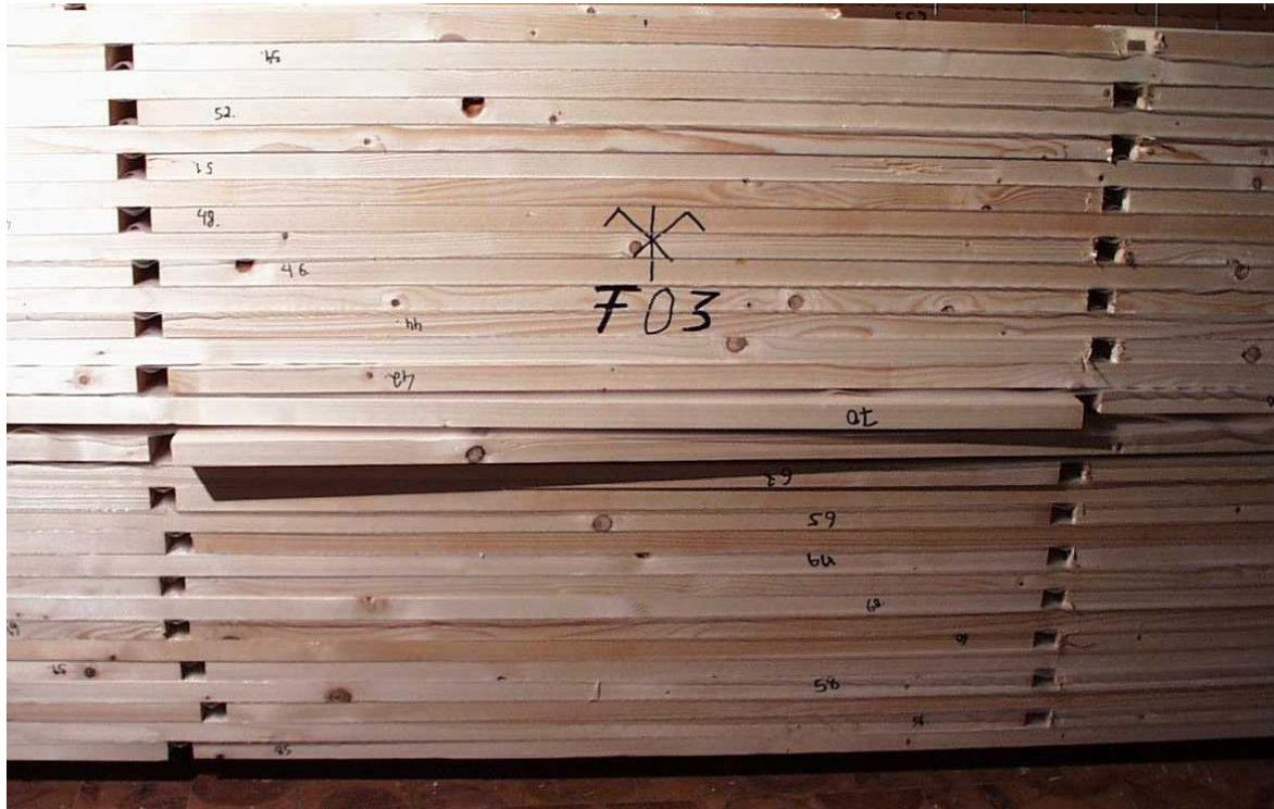
Bild 6- 8 Versagen eines Prüfkörpers infolge des gegenseitigen Abscherens der Lamellen im Lasteinleitungsbereich
