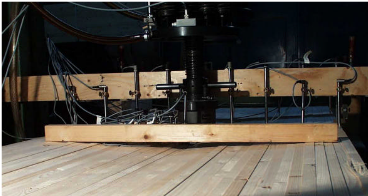
Bild D- 2 Prüfkörper unter Belastung, ungestoßene Lamellen - zentrische Einzellast; neun Wegaufnehmer im Bereich der Lasteinleitung quer zur Spannrichtung
