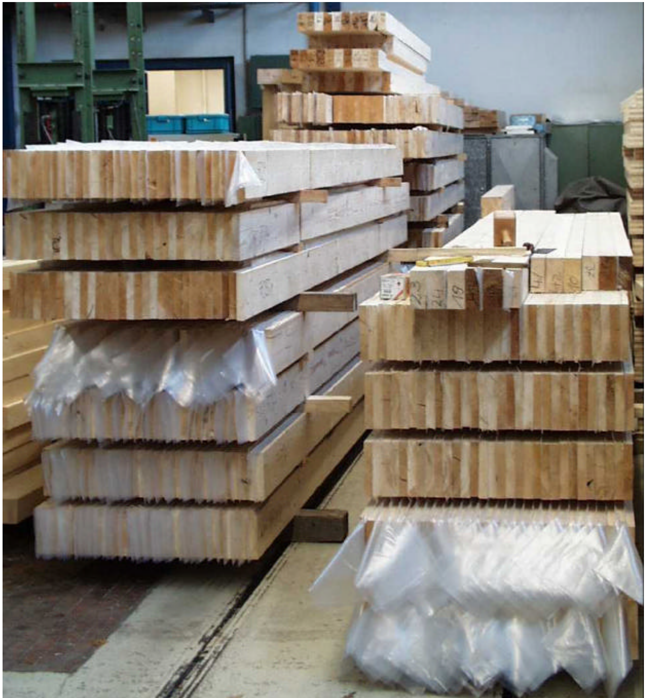
Bild D- 1 Prüfkörper in der Holz-Prüfhalle, teilweise mit überstehenden PE-Folien (zwei pro Scherfuge)
