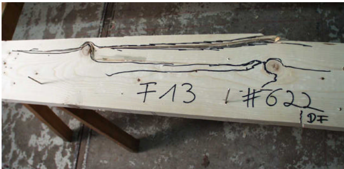
Bild D- 7 Versagen einer Lamelle durch das Erreichen der Biegefestigkeit, rechts unten eine Druckfalte in der Lamelle
