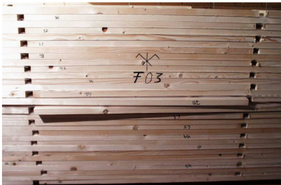
Bild D- 15 Untersicht eines Prüfkörpers mit wechselseitig gestoßenen Lamellen, lokales Durchstanzen der Lamellen
