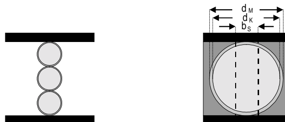
Abb. 2.7: Strahlungseinkopplung mit mehreren dünnen Fasern oder einer dicken Faser mit Faserkern-durchmesser d_k und -manteldurchmesser d_M . Die abstrahlende Fläche der größeren Faser wird durch eine Spaltblende mit einer Breite b_s begrenzt.
