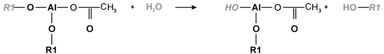
Abb. 7-2 Hydrolyse eines Metallorganyls nach Ausbildung der Polymer-Vorstufe. Polymerisation ist aufgrund der Sauerstoffbrücken innerhalb der Struktur möglich, eine vollständige Hydrolyse wird durch Säurezugabe unterbunden.
