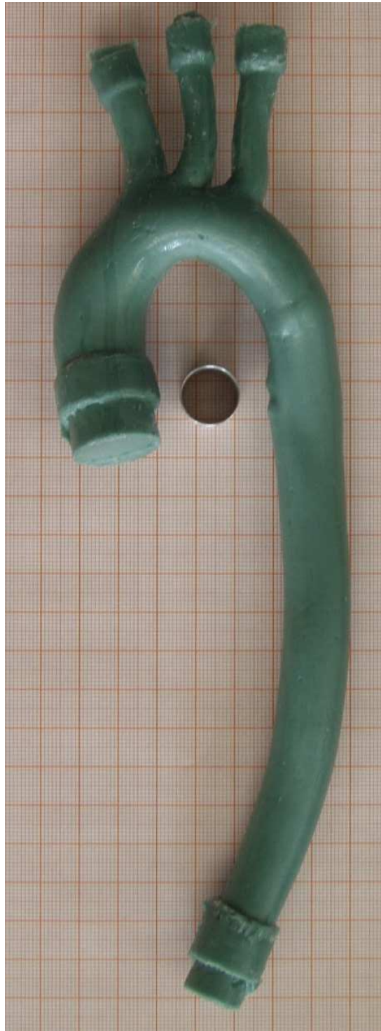
Abbildung 5.18: Wackskern des Aortenbogen-Modells
