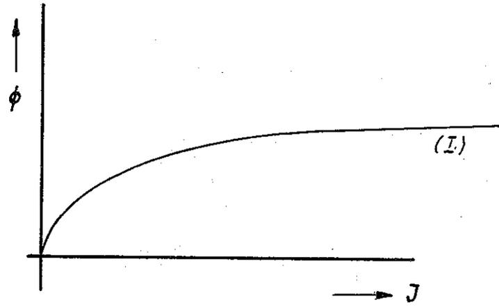
Die Zeichnung 1) zeigt den Verlauf des Neutronenflusses  $\phi$  in Abhängigkeit vom Kühlstrom J (in willkürlichen Einheiten).
