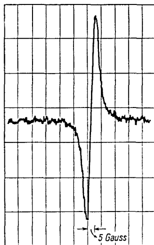
Abb. 27. Registrierkurve der 1. Abgeleiteten des paramagnetischen Resonanzspektrums von Diphenylpicrylhydrazyl. (Nach ZIMMER, EHRENBERG und EHRENBERG 1957.)
