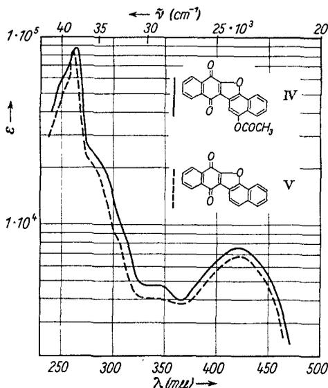
Abbild. 2. Absorptionsspektren des monoacetylierten Photoproducts (IV) und des Dinaphtho[1.2-*b*:2'.3'-*d*]furan-quinons-(7.12) (V). Lösungsmittel Methanol
