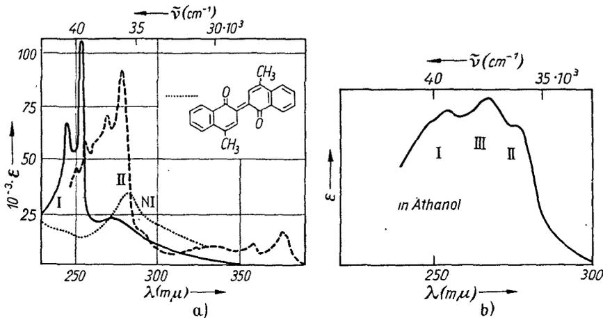
Abbild. 4. a) Spektren von NI, vor dem Belichten (NI), sofort nach dem Belichten (I), und nach einigen Stdn. Lösungsmittel Benzin
