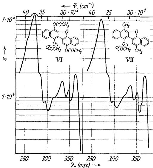
Abbild. 3. Absorptionsspektren des triacetylierten Photoproducts (VI) und des 7-Acetoxy-5.12-dimethyl-dinaphtho[1.2-*b*:2'.3'-*d*]furans (VII). Lösungsmittel Methanol
