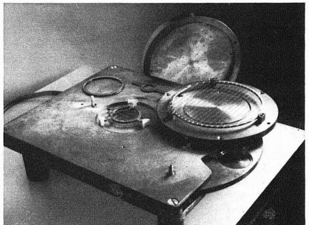
Abb. 5: Die geöffnete 2 \pi -Antikoinzidenzanlage. In der Mitte der Grundplatte ist der Meßzähler mit dem 28 cm 2 -Zählgitter und dem darunterliegenden Kathodengitter sichtbar. Der dahinter angebrachte helle Zylinder ist die Teflon-Isolierung der Hochspannungszuführung für den Schutzzähler. Rechts der geöffnete Schutzzähler mit dem deutlich erkennbaren Zählgitter, dahinter der Schutzzählerdeckel mit dem Zählgasverteiler. Auf der hinteren Ecke der Grundplatte liegen die beiden anderen, wahlweise einsetzbaren Zählgitter. Im Vorderteil der Grundplatte der Ausblasstutzen des Zählgases.
