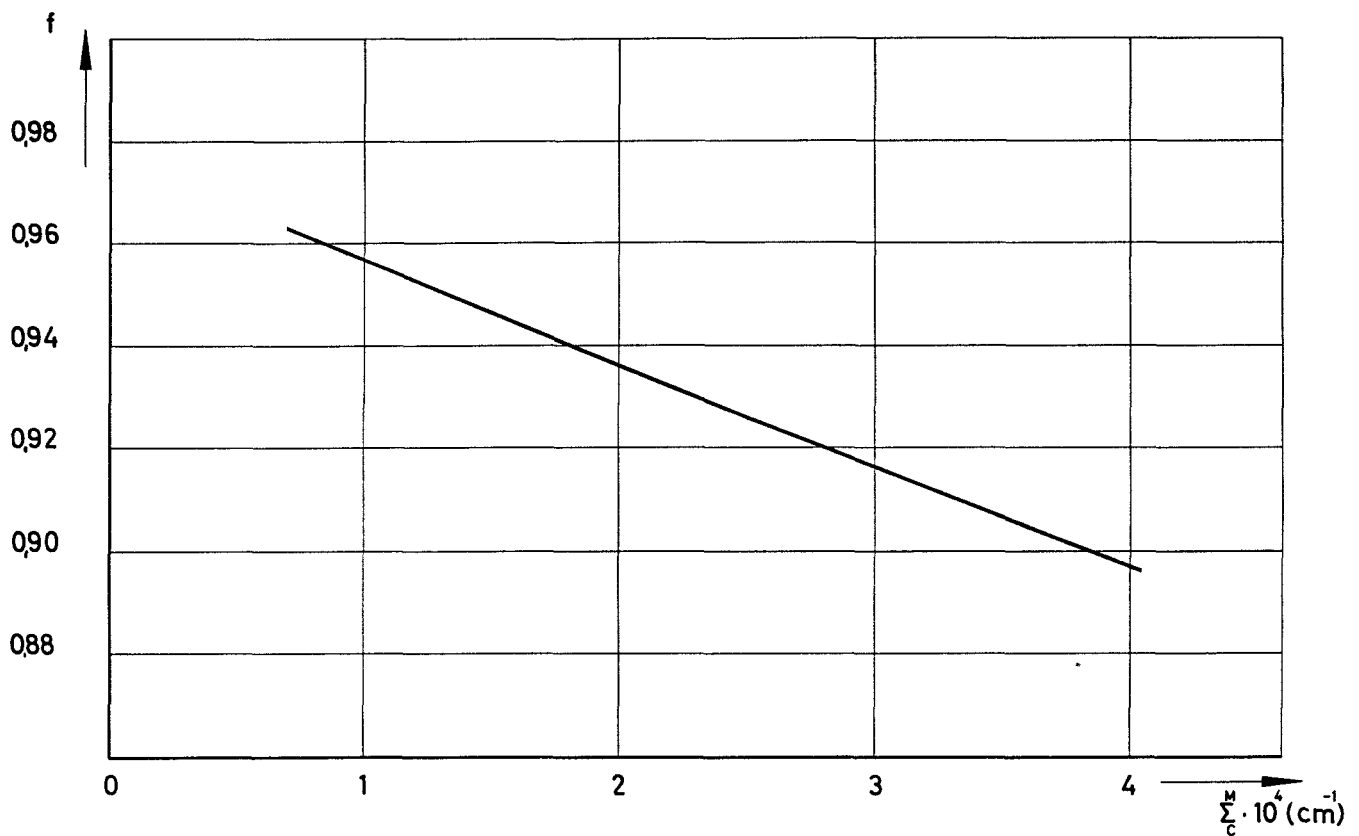
Abb. 2 Thermische Nutzung f in Abhängigk. vom therm. Absorptionsquerschnitt des Moderators
