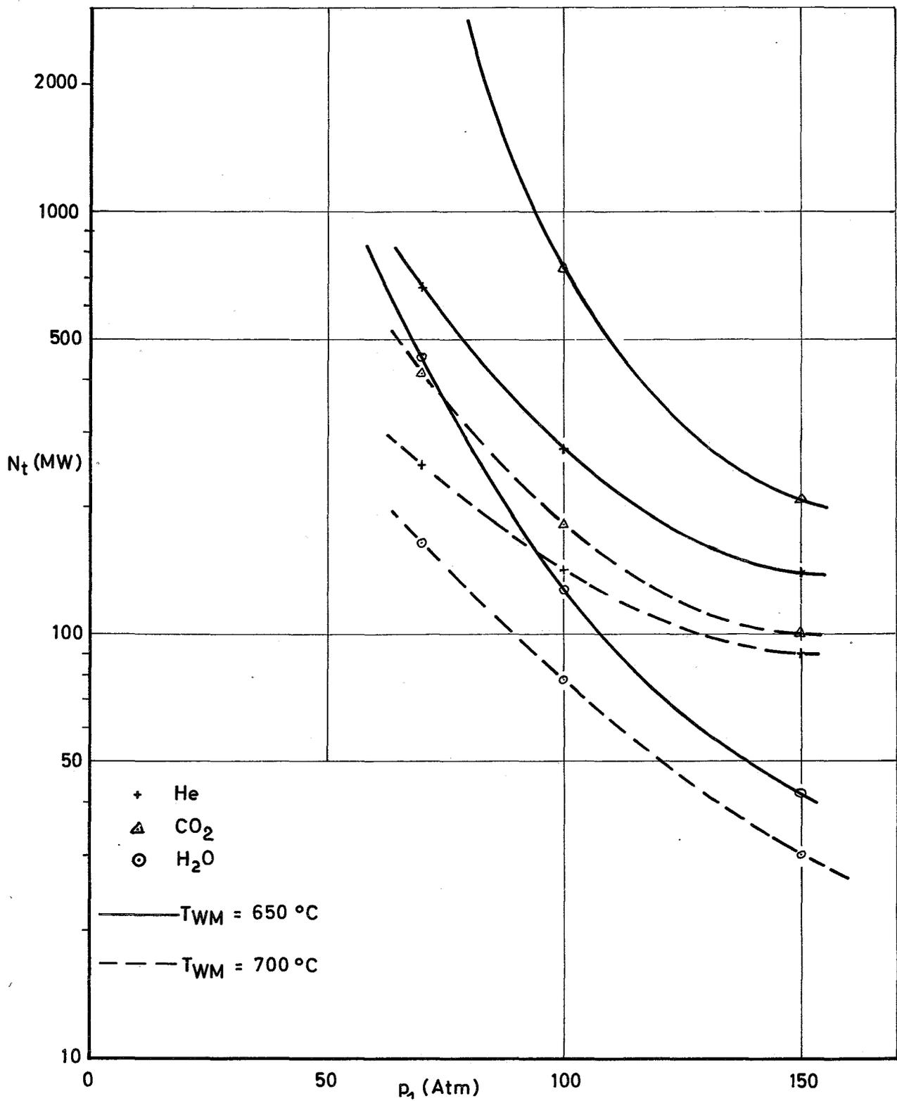
FIG. 4 PUMPING POWER REQUIRED BY THE COOLANT PRIMARY CIRCUIT FOR A CONSTANT NETT ELECTRICAL OUTPUT OF 1000 MWe.
