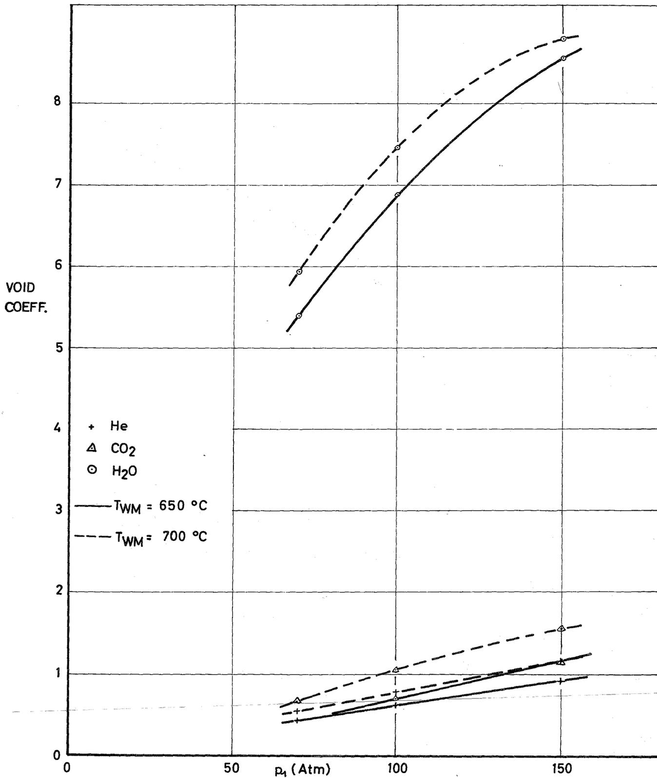
FIG. 9 VOID COEFFICIENT ( § )
