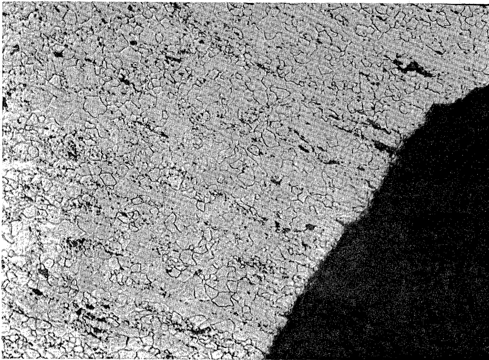
Abb. 8. Gefüge einer Zeitstandprobe im Bereich der Bruchzone; V-20Ti-Legierung, T = 800^{\circ}\text{C} , \sigma = 10 \text{ kp/mm}^2 , Vakuum \sim 1 \times 10^{-5} Torr. ( \times 400 )
