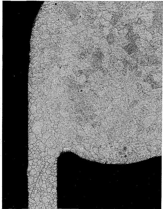
Bild 13: Zugeschmolzenes Ende eines Kupferrohres 8 × 1,5 mm, Übergang vom Rohr zur Schweißperle, etwa 10fach vergrößert
