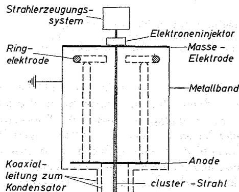
Abb. 1. Anordnung zur Erzeugung elektrischer Entladungen in Wasserstoff-cluster-Strahlen. — Die Koaxialleitung liegt außerhalb der Symmetrieachse des Elektroden systems, räumlich getrennt vom cluster-Strahl.
