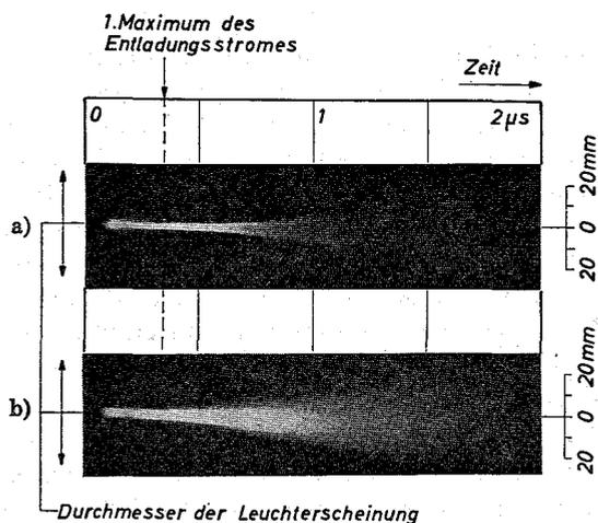
Abb. 4. Schmierbilddarstellungen des Plasmaquerschnitts
