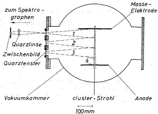
Abb. 2. Anordnung zur Messung des Emissionsspektrums.
