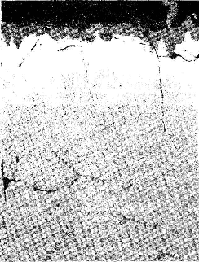
Bild 8. Wechselwirkung zwischen Zirkoniumdioxid (dunkelgrau) und einer V-Ni-Legierung (weiß), ungeätzt. 250 x
