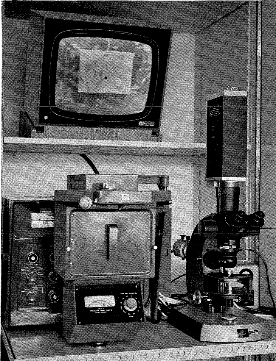
Bild 1: Gesamtansicht des Quantimet mit Zeiss-Mikroskop
