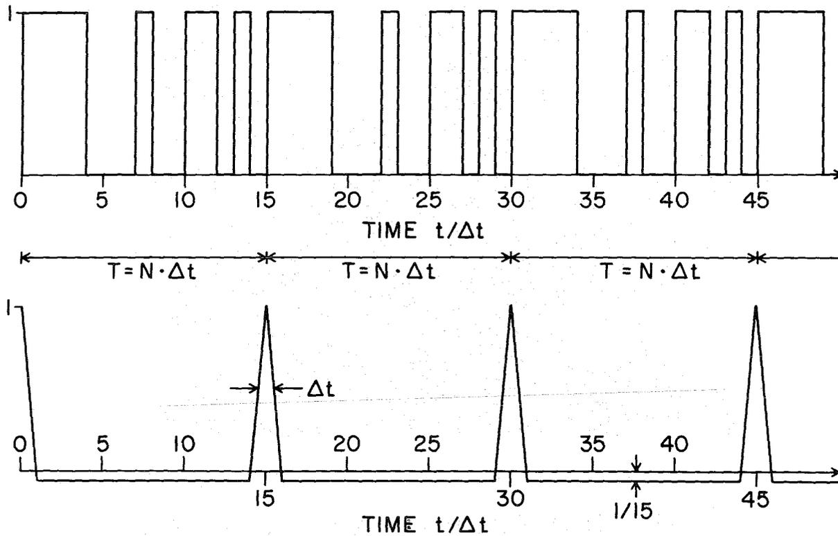
Fig. 4 GAIN FACTORS FOR STATISTICAL vs NORMAL BEAM MODULATION
