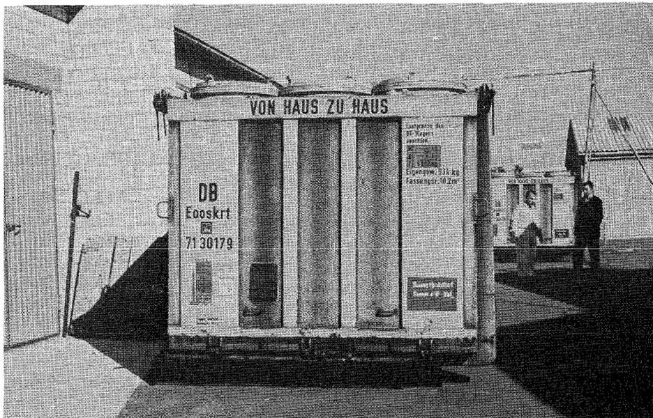
Abb. 6 Bundesbahncontainer mit niedrigradioaktiven Rückständen auf dem Werksgelände der Gesellschaft für Kernforschung.
