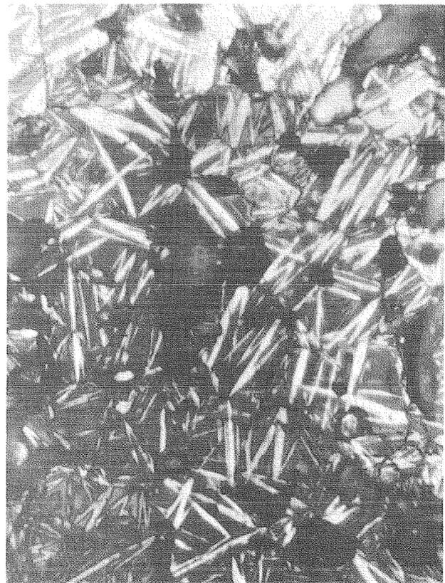
UC-Phase, geätzt, 2000x
